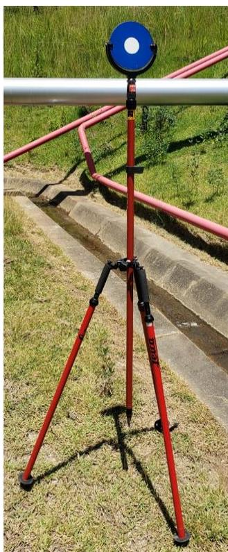
Figura 49 - Alvo utilizado para definição de pontos de controle montado em tripé
