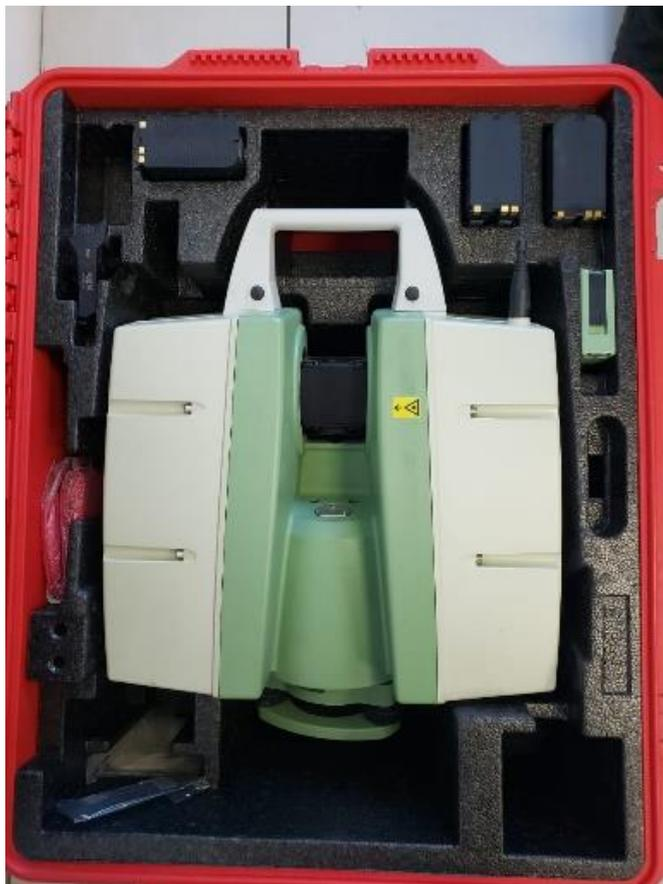
Figura 45 - Escâner industrial modelo C10 da Leica Geosystems
