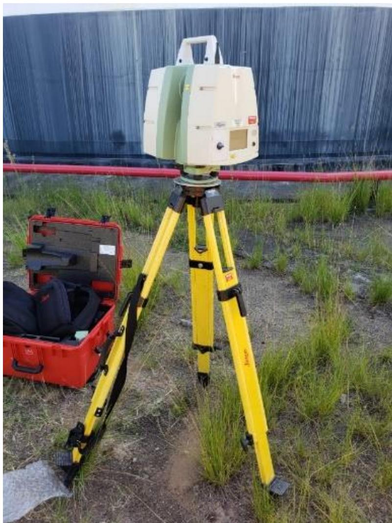
Figura 46 – Escâner montado em tripé
