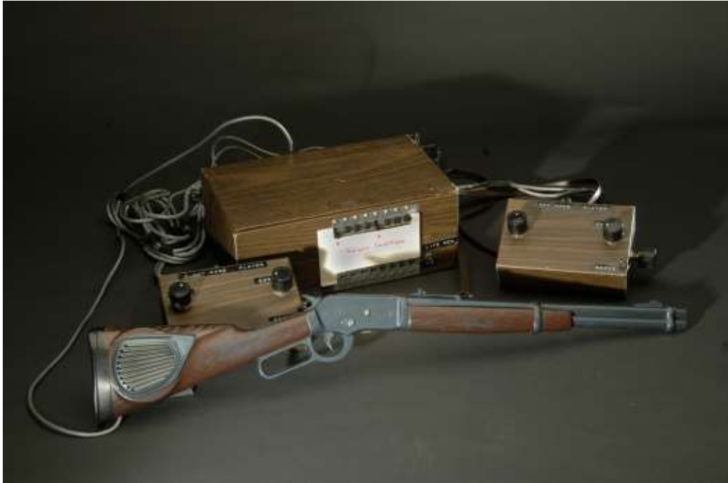
Figura 7 - O Browbox desenvolvido por Ralph Baer and Bill Harrison e Bill Rusch
