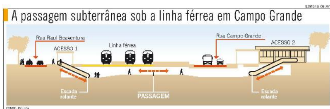
Figura 65 - Representação artística, publicada no O Globo em 17/06/2007, da reconfiguração e modernização da passagem subterrânea de Campo Grande, Rio de Janeiro pelo projeto Urb-Cidade, governo César Maia
