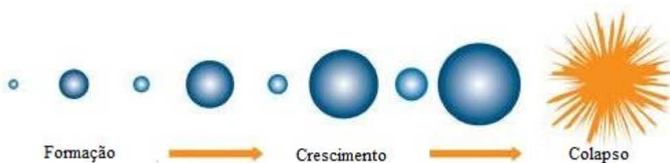
Figura 13 – Esquema da formação, crescimento e colapso de bolhas na cavitação
