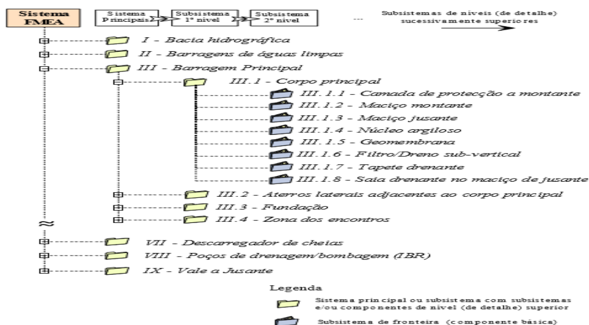
Figura 23 - Hierarquização funcional de uma barragem
