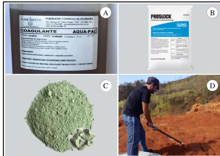
Legenda: Material químico utilizado nos experimentos. cloreto de polialumínio (PAC) – (A), bentonita modificada com lantânio (LMB) – (B), zeolita (ZEO) – (C), solo natural vermelho (RS).
