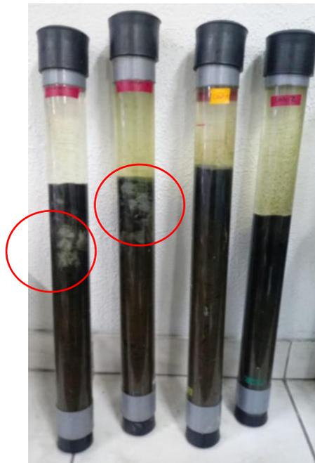
Legenda: A penetração do LMB no sedimento, visivelmente observado no círculo vermelho destacado.
