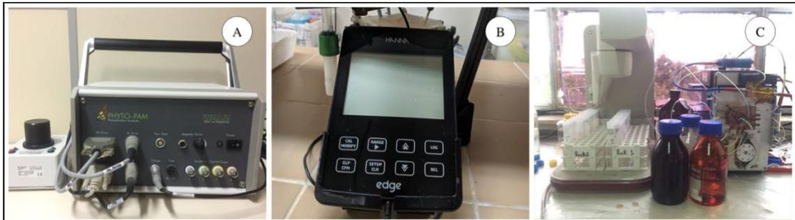
Legenda: Equipamentos utilizados para análises de Chl-a, pH, OD, FSR e PT das amostras retiradas dos cores. (A) Analisador de fitoplâncton (PHYTOPAM), (B) pHmêtro e oxímetro digital e (C) sistema automático de ensaios baseados em análise colorimétrica por injeção de fluxo (FIALab-2500).
