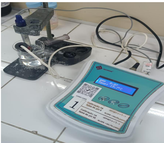
Figura 10 - Mensuração do pH realizado em laboratório a partir de amostra de água coletada da Bacia Hidrográfica do Rio Guandu
