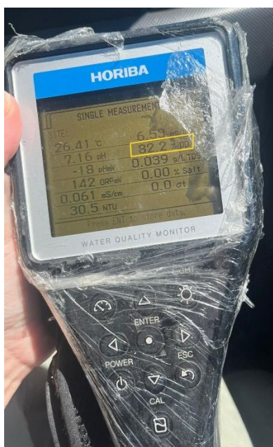
Figura 8 - Mensuração do parâmetro OD realizada a campo a partir de amostra de água coletada da Ba-cia Hidrográfica do Rio Guandu
