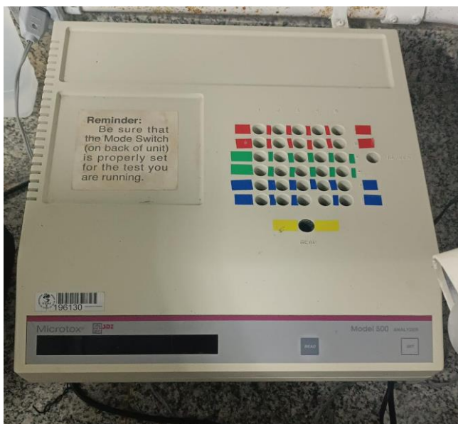
Figura 16 - Aparelho de Microbioc Microtox utilizado nos ensaios de toxicidade aguda de Vibrio fischeri
