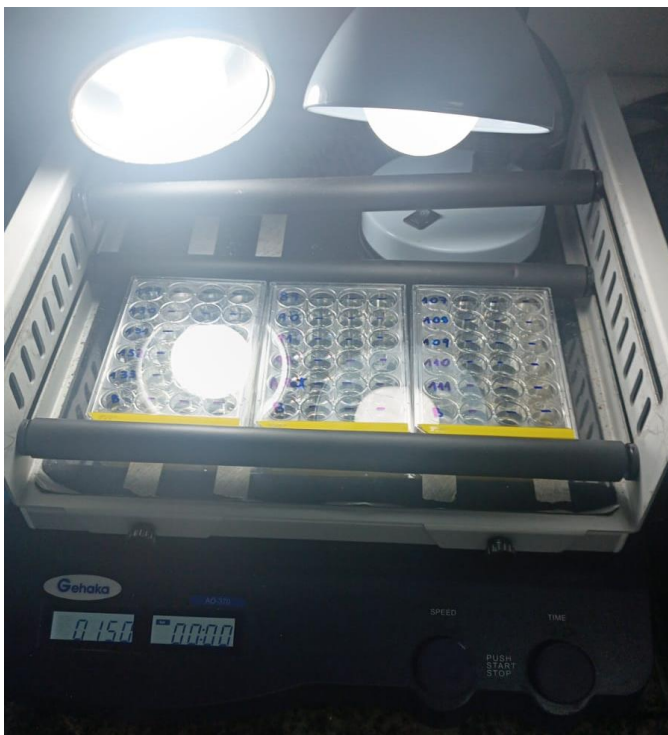
Figura 15 - Ensaio de Raphidocelis subcapitata sendo realizado com placas de 24 poços, acondicionadas a temperatura, agitação e luminosidade controlada
