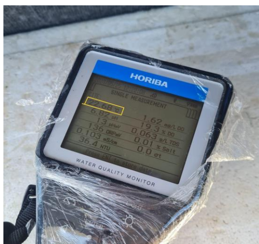
Figura 12 - Mensuração realizada em campo com o parâmetro temperatura em destaque
