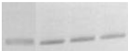
Figura 25 - Eletroforese em gel de agarose (0,8%) de plasmídeo pUC 9.1 incubado com Trissulfeto de dibenzila (DTS)
