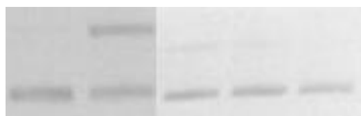
Figura 26 - Eletroforese em gel de agarose (0,8%) de plasmídeo pUC 9.1 incubado com Trissulfeto de dibenzila (DTS) associado à radiação ionizante 60 Gy
