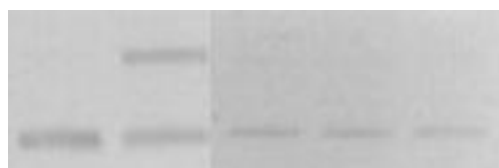
Figura 24 - Eletroforese em gel de agarose (0,8%) de plasmídeo pUC 9.1 incubado com Dissulfeto de dibenzila (DDS) associado à radiação ionizante 60 Gy
