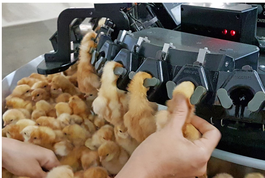
Figura 10 - Debricagem de pintinhas por infravermelho
