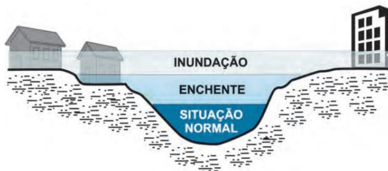
Figura 2 – Perfil esquemático dos processos de enchente e inundação
