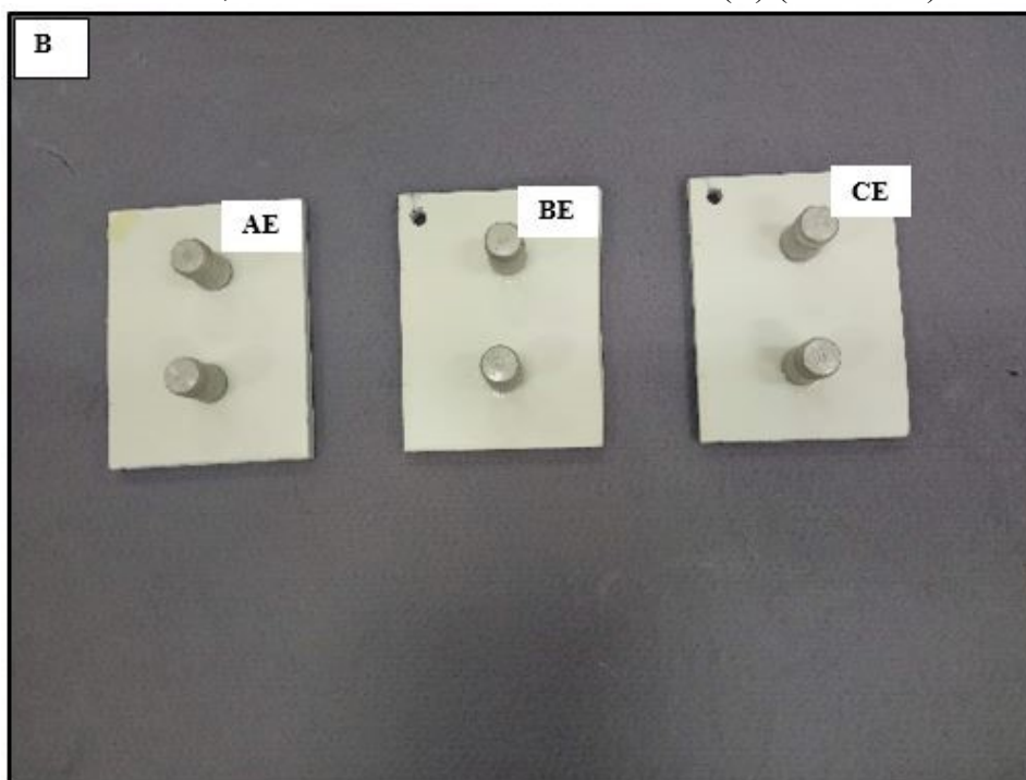
Figura 21 – Equipamento POSITEST® AT-A (A) e os corpos de provas AE, BE e CE com os carretéis colados (B) (conclusão).
