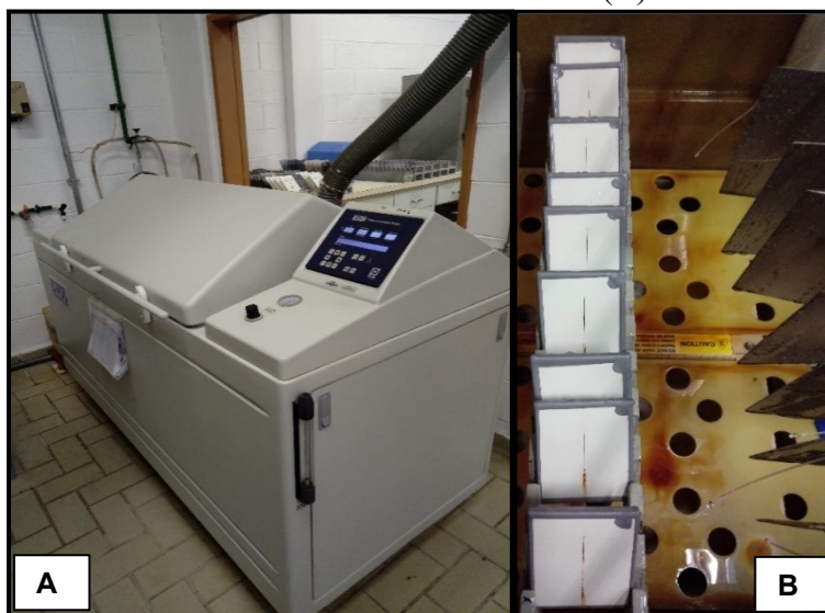
Figura 20 – Câmara de pulverização (A) e substratos metálicos com e sem incisão (B).
