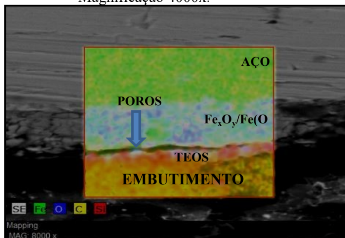
Figura 40 - Micrografia da seção transversal e análises de mapeamento dos principais elementos presentes do sistema Aço/AMT/TEOS (Experimento 13). Magnificação 4000x.
