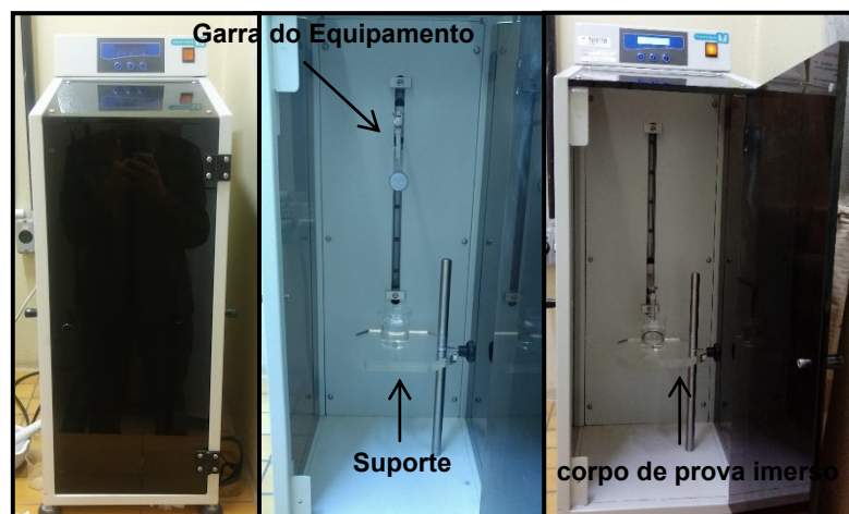
Figura 13 – Ensaio de imersão dos sistemas AMT/silanos utilizando o sistema dip coating .
