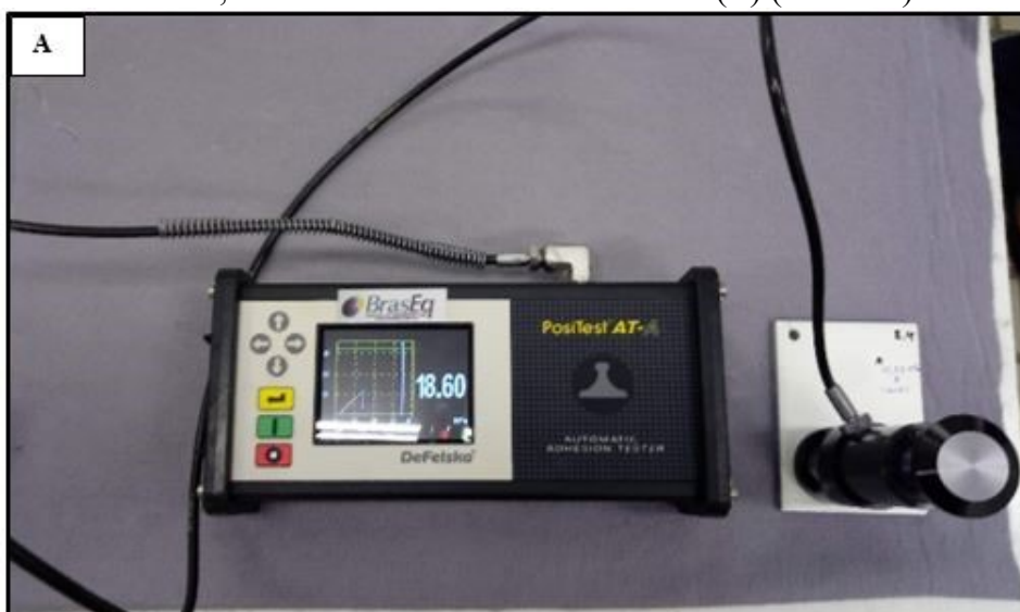
Figura 21 – Equipamento POSITEST® AT-A (A) e os corpos de provas AE, BE e CE com os carretéis colados (B) (continua).
