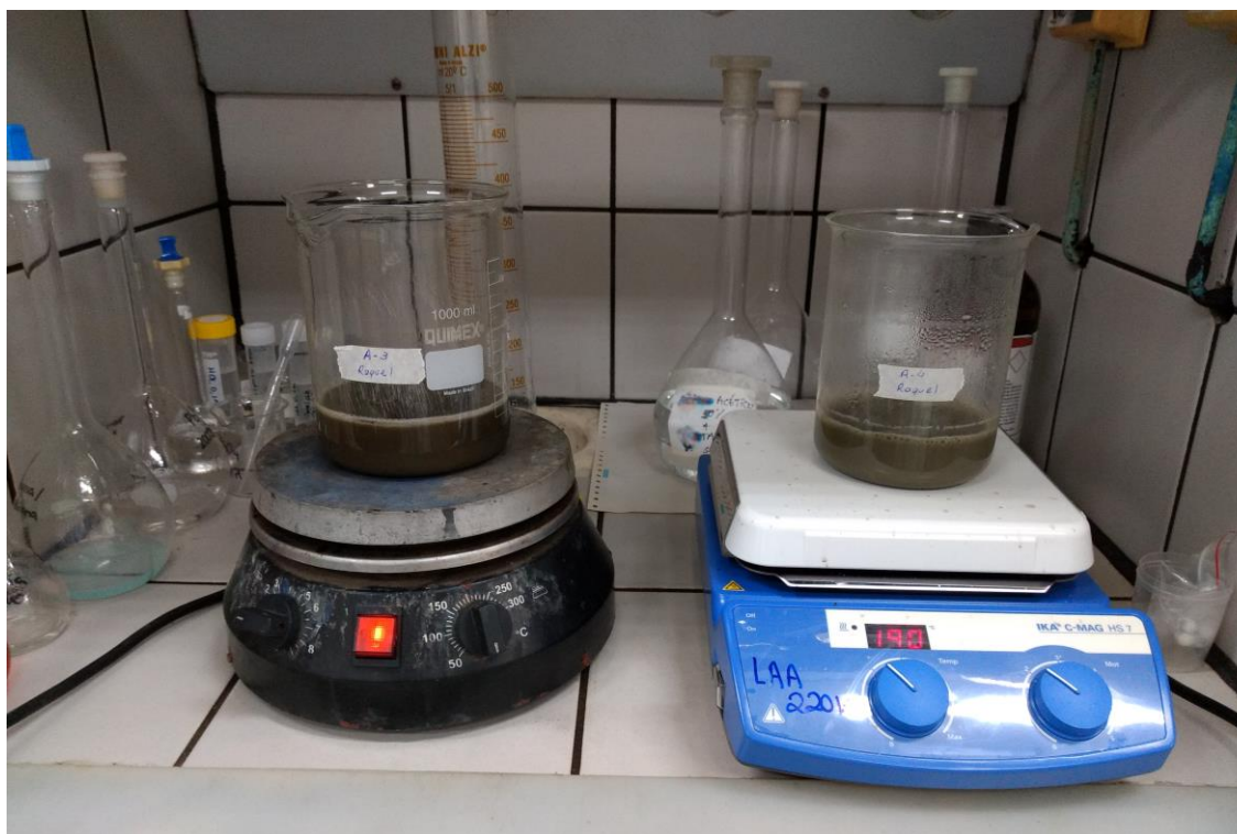
Figura 22 - Béquer de vidro com amostras sofrendo o processo de carbonatação
