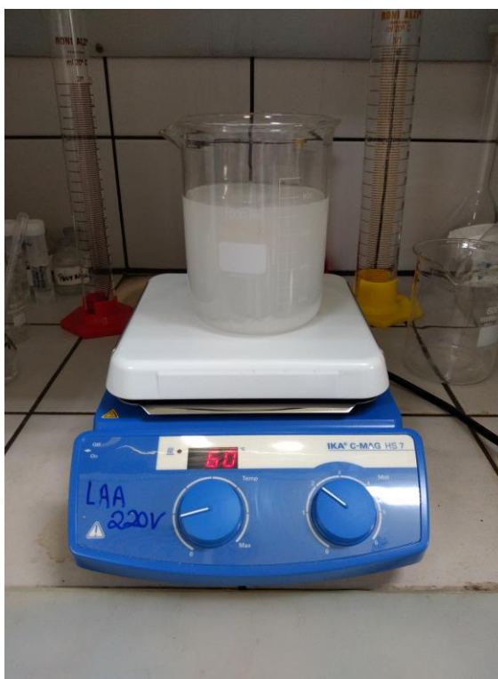
Figura 20 - Solução de Ácido Acético (10%) e Acetato de Sódio (10%) sobre agitador magnético da marca IKA C MAG HS 7.
