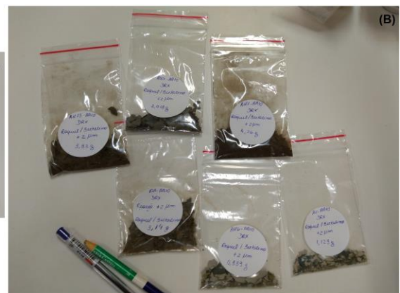
Figura 26 – Amostras das mineradoras Santa Fé e Aligra proveniente da separação da fração argila. (A) Menor que duas micras. (B) Maior que duas micras.
