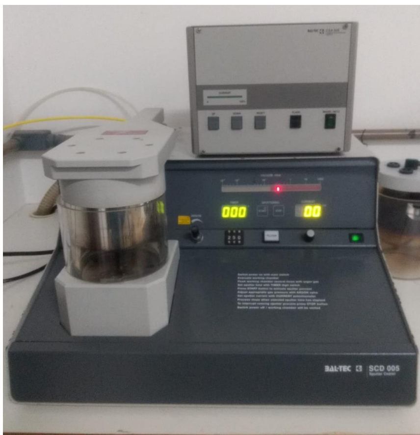
Figura 29 - Câmara de uma metalizadora da marca Baltec SDC 005
