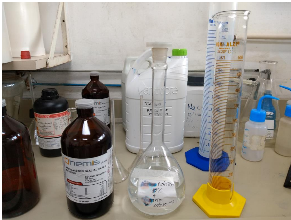
Figura 21 - Ácido Acético (10%), balão volumétrico com a solução de ácido acético (10%) com acetato de sódio (10%) e proveta de 500 mililitros.
