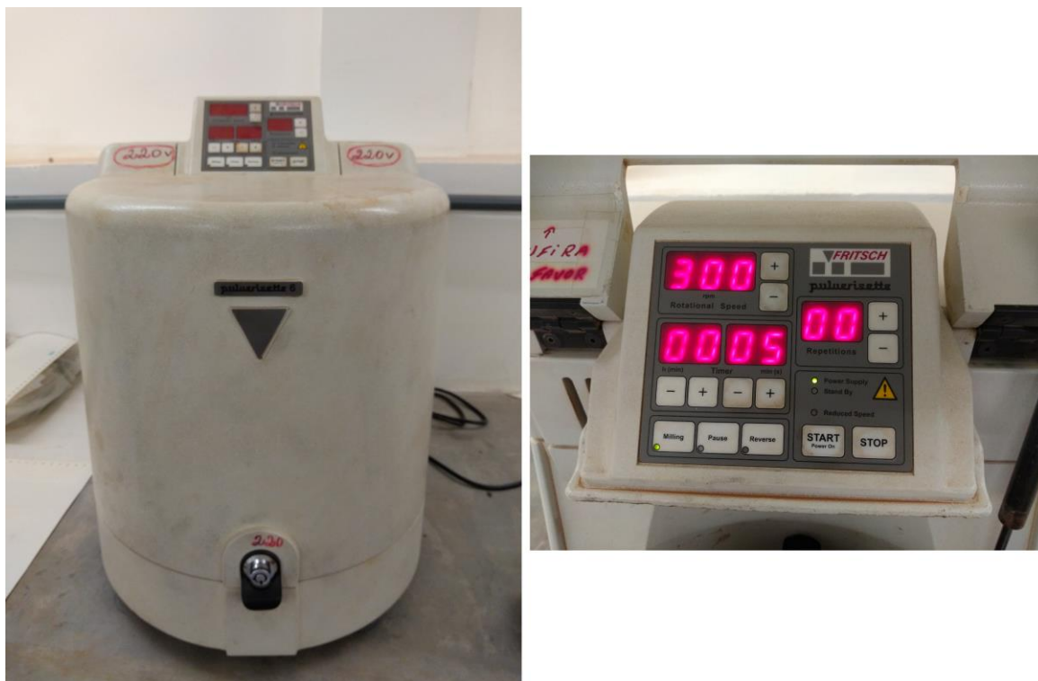
Figura 18 - Moinho planetário de bolas. Marca Fritsch; modelo Pulverisette 6.
