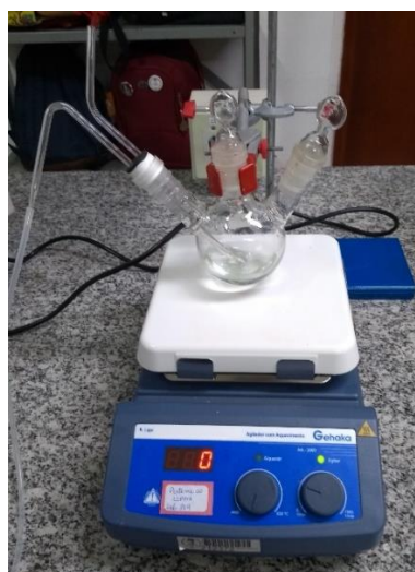
Figura 14 – Etapa de mistura e homogeneização dos reagentes, acrescida de borbulhamento de N_2 - Método HUN
