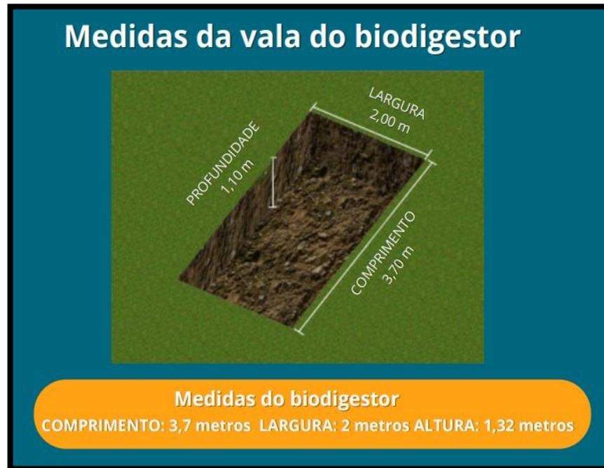
Fonte: BGS - Equipamentos para biogás.
