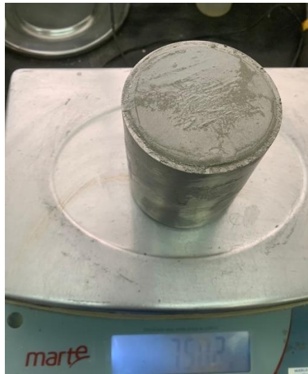
Figura 29 – Ensaio de massa específica do compósito.
