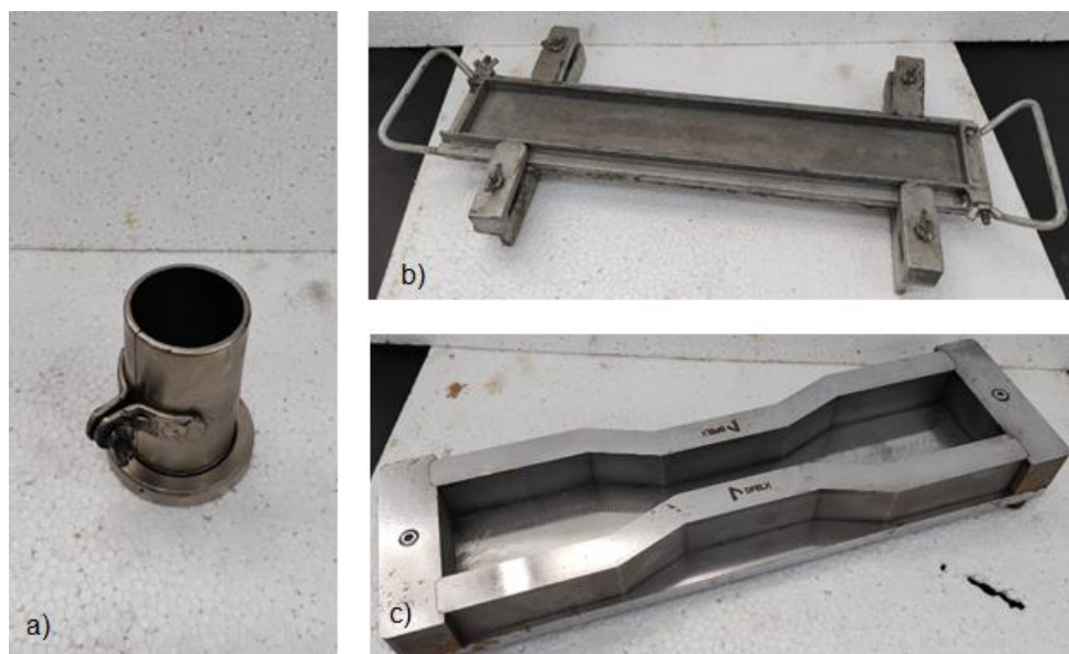
Figura 22 – Formas para moldagem dos ensaios de (a) compressão, (b) flexão e (c) tração direta.
