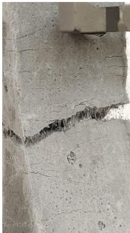
Figura 69 – Fissuras aparentes no corpo de prova após ensaio de tração direta.
