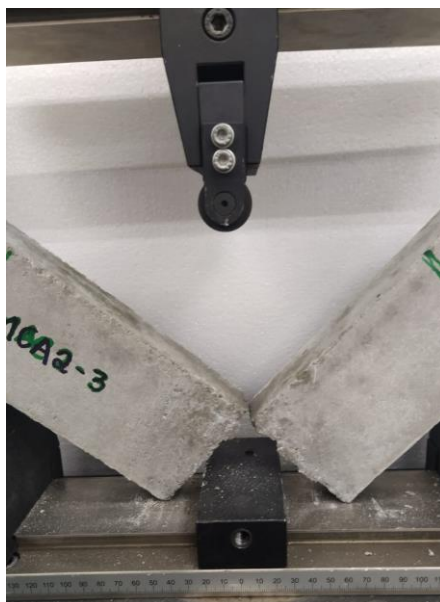
Figura 47 – Corpo de prova após a ruptura no ensaio de tenacidade.
