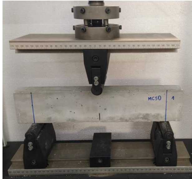
Figura 31 – Configuração de tenacidade à fratura da matriz dos compósitos.
