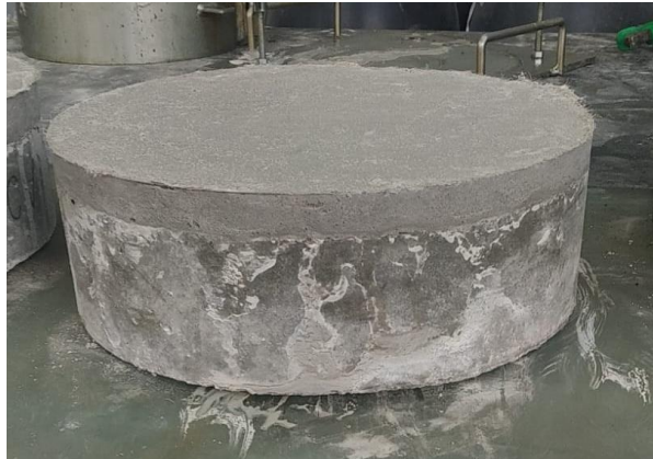
Figura 25 – Conjunto reparado (substrato de concreto + reforço de compósito) após desmoldagem.
