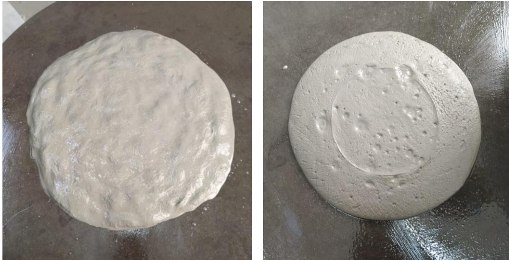
Figura 28 – Ensaio de consistência do compósito e da matriz do compósito.
