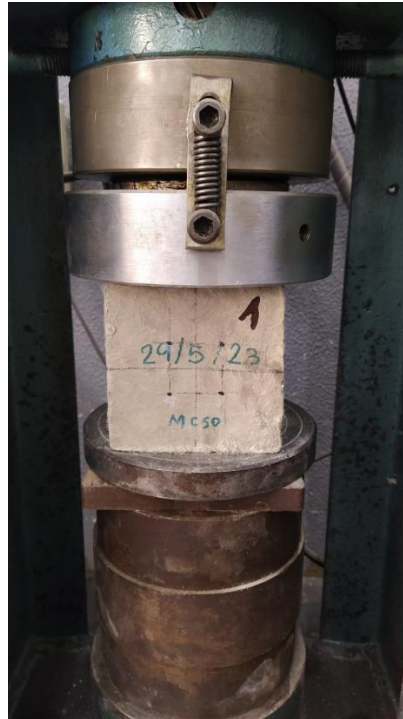
Figura 38 – Corpo de prova cúbico preparado para receber os golpes do esclerômetro.
