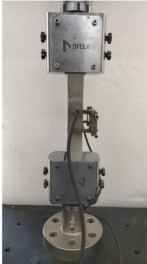
Figura 35 – Configuração de tração direta dos compósitos.
