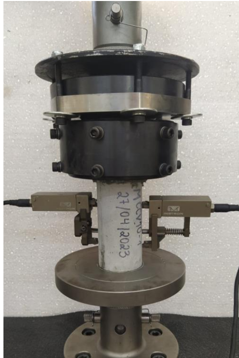
Figura 30 – Ensaio de compressão axial nos compósitos.
