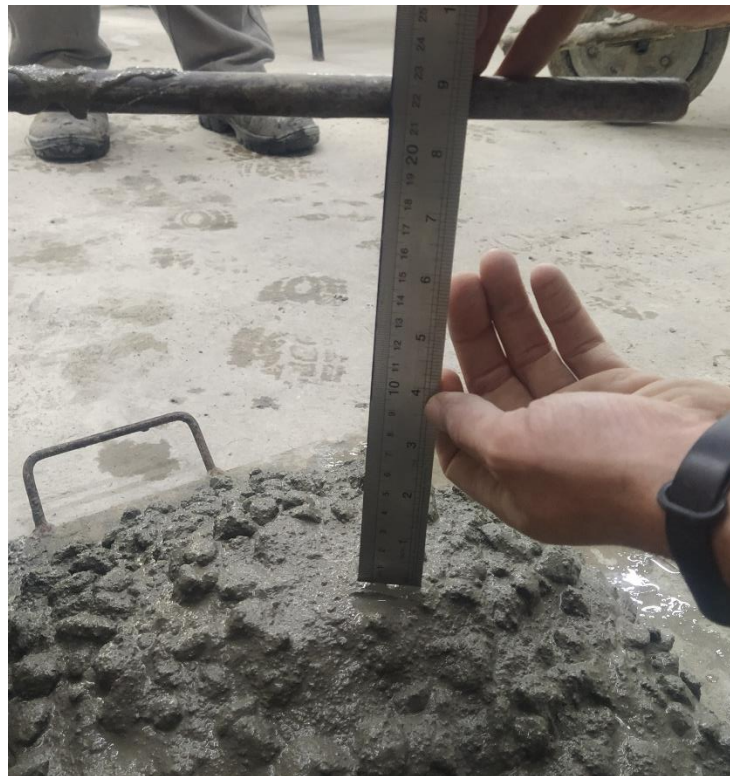
Figura 26 – Ensaio de abatimento do concreto.
