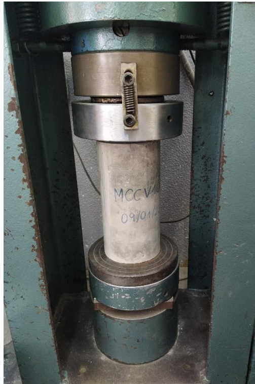
Figura 27 – Ensaio de resistência à compressão axial do concreto.
