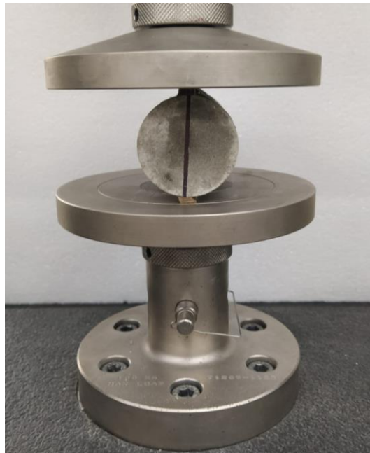
Figura 33 – Configuração de compressão diametral da matriz dos compósitos.
