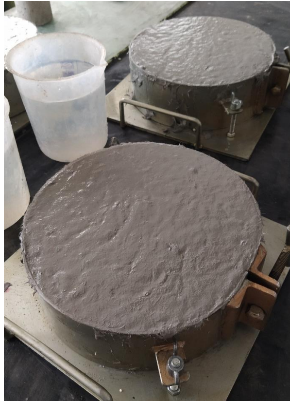
Figura 23 – Moldagem de compósitos para ensaio de erosão.
