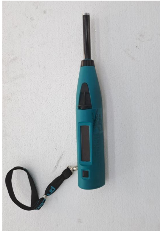
Figura 36 - Esclerômetro Digital utilizado no ensaio para determinação do índice esclerométrico.
