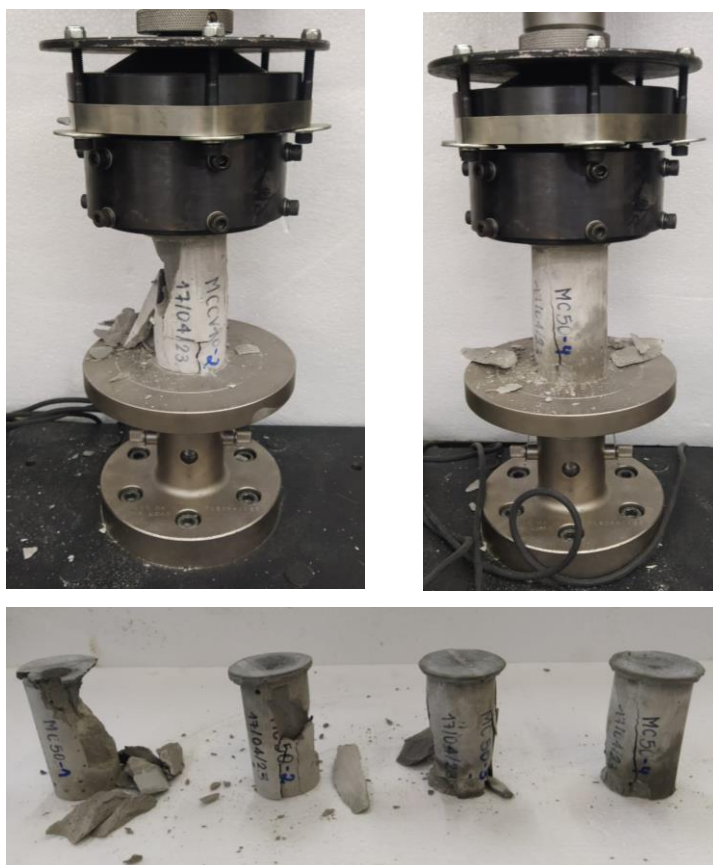
Figura 42 – Modo de ruptura da matriz quando exposta a força de compressão.
