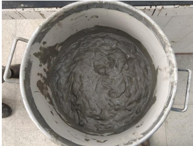
Figura 21 – Materiais após processo de mistura na argamassadeira.
