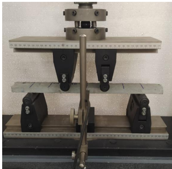
Figura 32 – Configuração de flexão dos compósitos.
