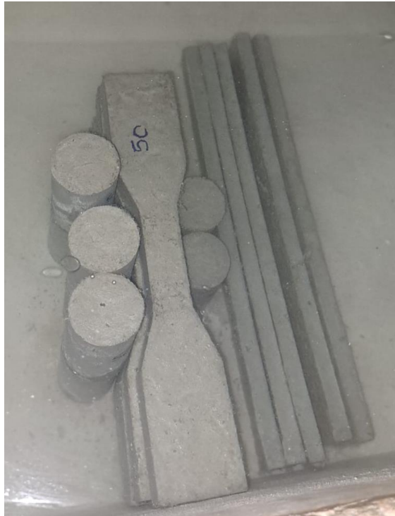
Figura 24 – Processo de cura dos compósitos.
