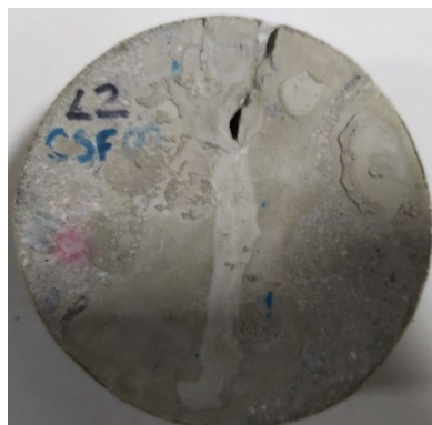
e) L2 – 30 dias após a fissuração
