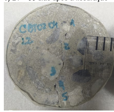
f) L2 – 60 dias após a fissuração
