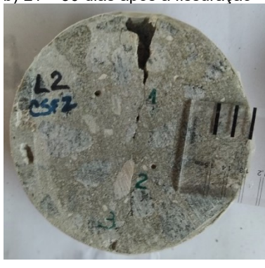
e) L2 – 30 dias após a fissuração
