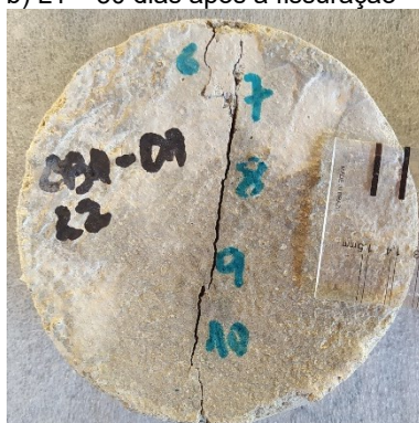
e) L2 – 30 dias após a fissuração
