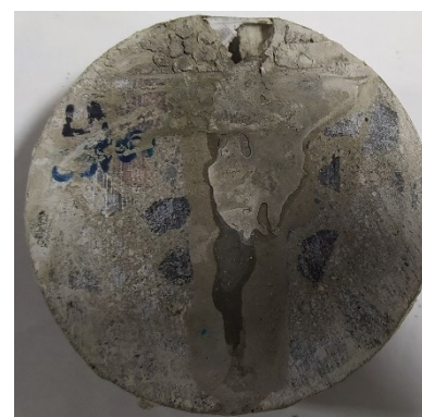
b) L1 – 30 dias após a fissuração
