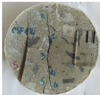
e) L2 – 30 dias após a fissuração
