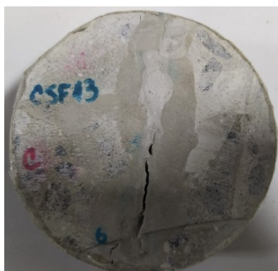
b) L1 – 30 dias após a fissuração
