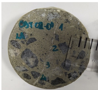
b) L1 – 30 dias após a fissuração
