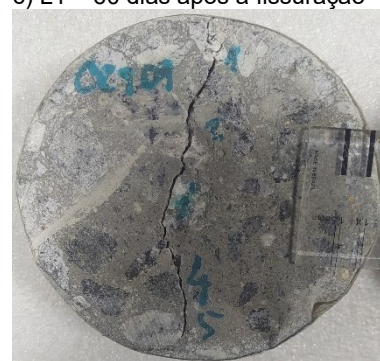
f) L2 – 60 dias após a fissuração
