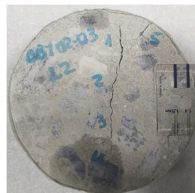
f) L2 – 60 dias após a fissuração
