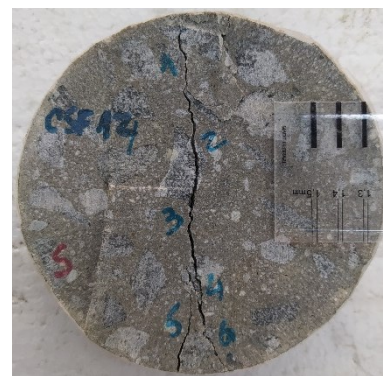
f) L2 – 60 dias após a fissuração
