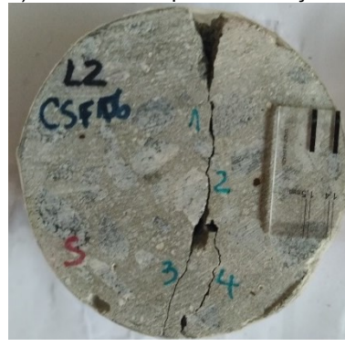
e) L2 – 30 dias após a fissuração
