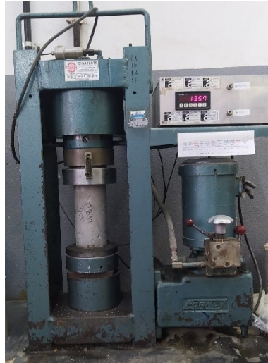
Figura 15 – Fissuração dos corpos de prova
