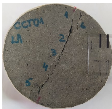
b) L1 – 30 dias após a fissuração
