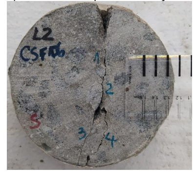
f) L2 – 60 dias após a fissuração
