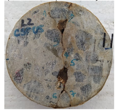
f) L2 – 60 dias após a fissuração
