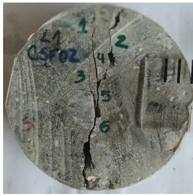
b) L1 – 30 dias após a fissuração
