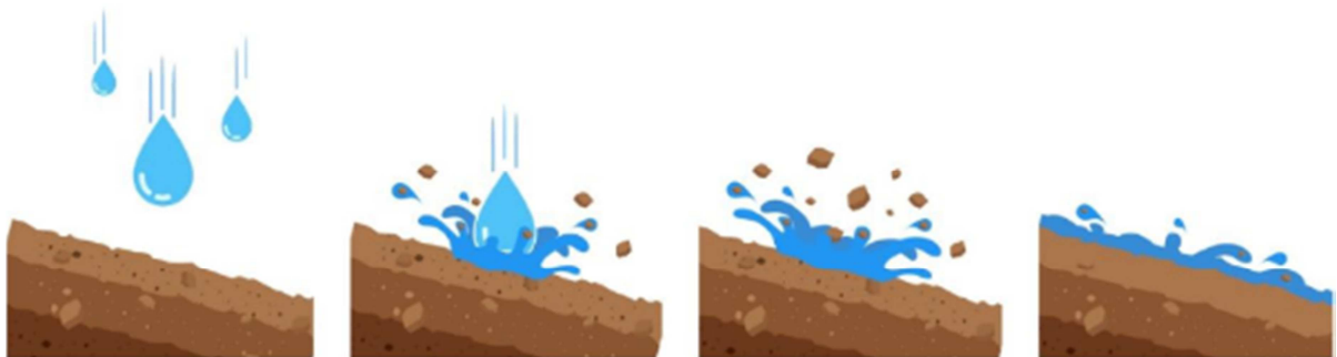
Figura 14 - Efeito Splash no solo causado pelo impacto das gotas de chuva
