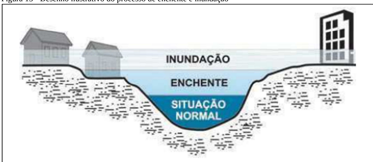
Figura 15 - Desenho ilustrativo do processo de enchente e inundação
