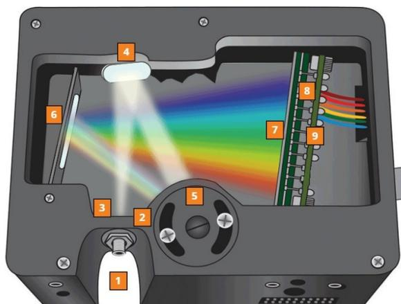
Legenda: Propagação da luz dentro do espectrômetro *USB 4000*.
