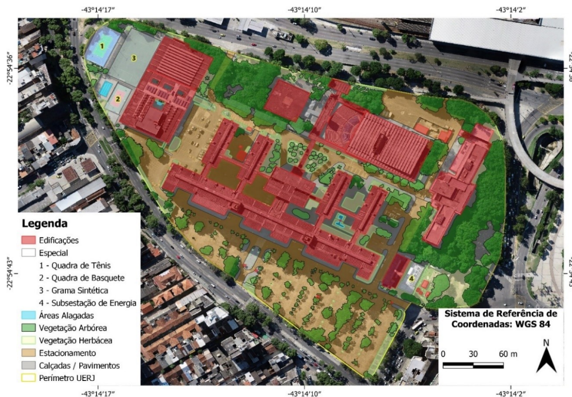
Figura 9 – Classificação de Uso e Ocupação do Solo da área do Campus UERJ Maracanã, Rio de Janeiro-RJ, obtida a partir de ortoimagem de sobrevôo por drone
