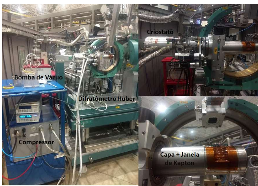
Figura 27 - Arranjo experimental utilizado nas medidas de DRX em baixas temperaturas
