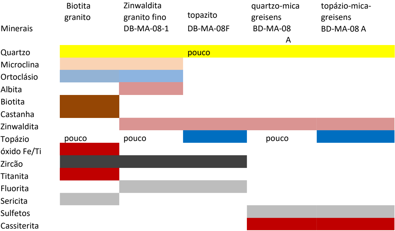
Figura 43 - Paragênese mineral obtida pela análise petrográfica das amostras relacionadas ao Endogreisen A. Paragênese mineral dos endogreisens ponto DB-MA-08
