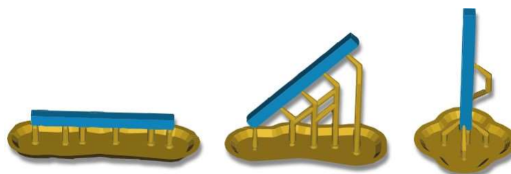
Figura 1 – Ilustração das três diferentes orientações de impressão 0° (esquerda), 45° (no centro) e 90° (direita) dos corpos de prova (azul) com seus respectivos suportes (amarelo)
