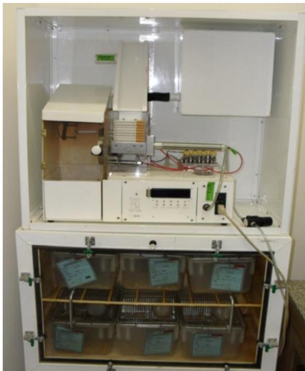
Legenda: Fotografia em vista frontal da máquina, com o equipamento de geração da fumaça do cigarro na porção superior e a câmara de exposição contendo gaiolas na porção inferior.
