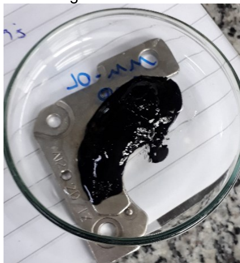
Figura 23 - Material magnético tratado com ácido oleico sob ação do campo magnético de um ímã
