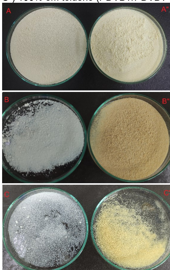
Figura 53 – Comparação lado a lado (resinas não funcionalizadas/resinas funcionalizadas) das resinas com grau de diluição (A/A'') 100% em n-heptano (PDVBH/PDVBH MF), (B/B'') 150% em n-heptano (PDVB150H/PDVB150H MF) e (C/C'') 100% em tolueno (PDVBT/PDVBT MF)
