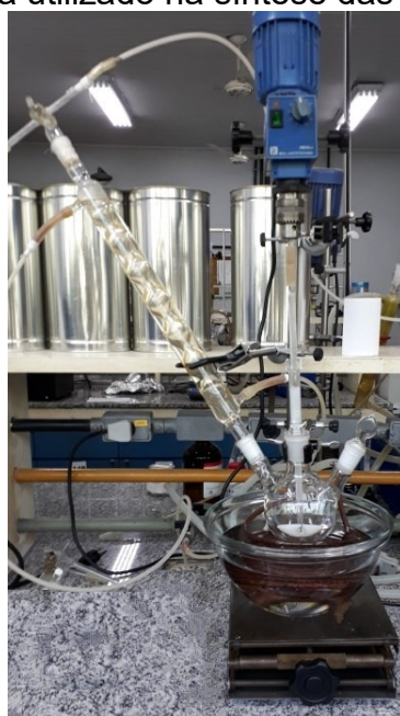
Figura 17 - Sistema utilizado na síntese das resinas poliméricas
