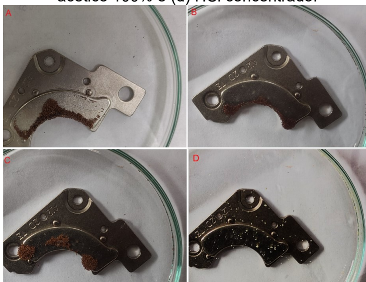
Figura 43 – Avaliação da lixiviação do material magnético da resina magnética: (a) antes do contato com ácido (controle), (b) solução de HCl (0,001 mol/L), (c) ácido acético 100% e (d) HCl concentrado.
