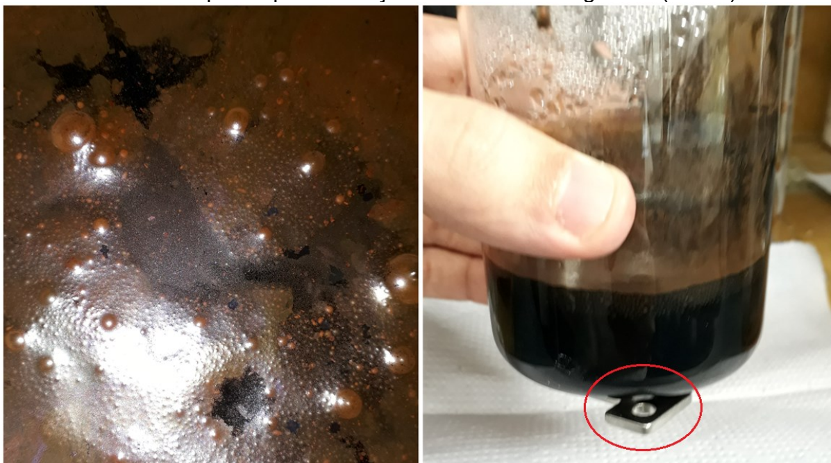
Figura 22 – Camada de sobrenadante sobre o material magnético (esquerda) e Ímã sendo suspenso pela interação com material magnético (direita)
