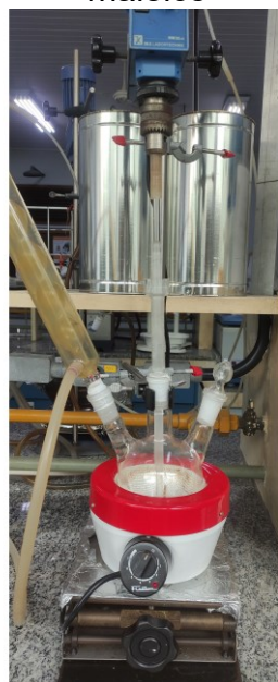
Figura 19 – Sistema utilizado para reação de modificação das resinas com anidrido maleico
