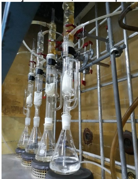
Figura 18 - Sistema de extração Soxhlet, utilizado para a purificação das resinas
