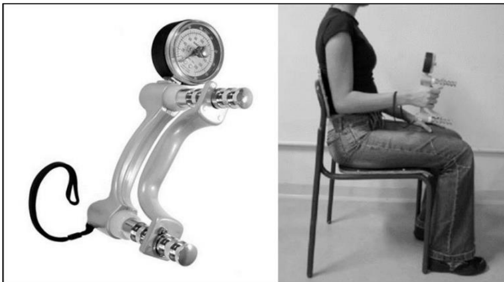
Figura 2 - Dinamômetro manual Jamar e posicionamento adequado para realização da FPM
