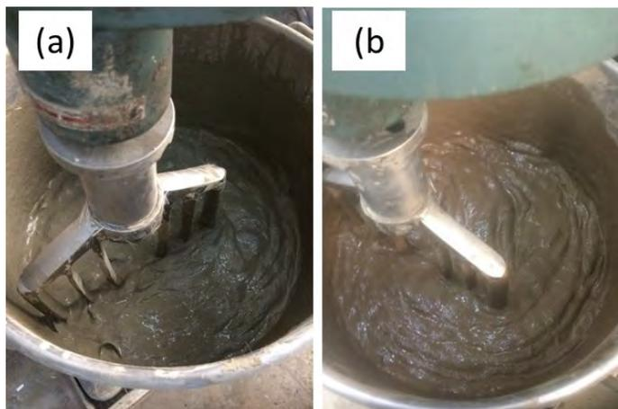
Figura 94 – Produção das misturas – Comparação das misturas de ECC (a) sem e (b) com adição de 30% de estéril (Fonte: A autora, 2024).
