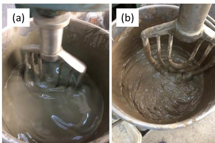
Figura 95 – Aspecto da mistura C20 (a) antes e (b) depois da aplicação das fibras (Fonte: A autora, 2024).
