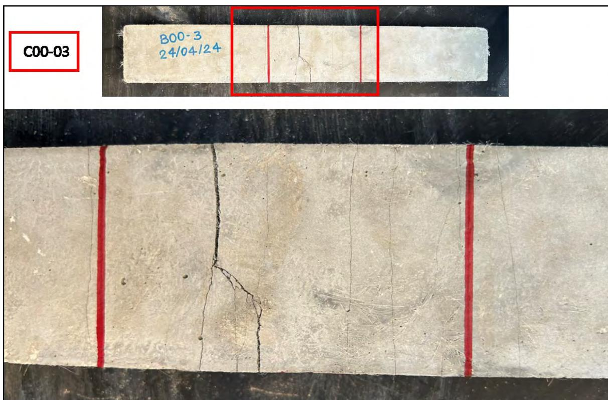
Figura 145 – Registro fotográfico – Ensaio de flexão do corpo de prova C00-03 (Fonte: A autora, 2024).
