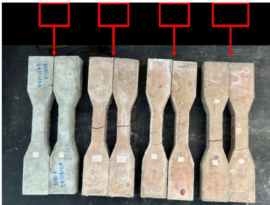
Figura 110 – Corpos de prova de ECC ensaiados à tração (Fonte: A autora, 2024).
