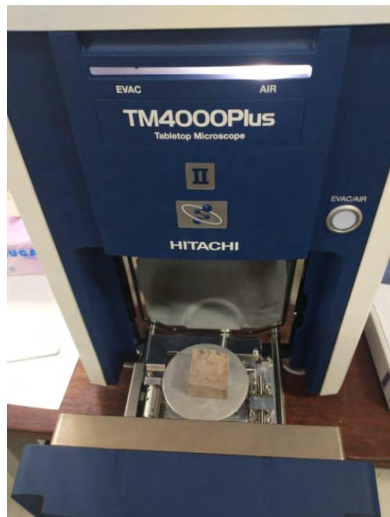
Figura 41 – Realização das análises MEV nas superfícies de fratura dos corpos de prova de ECC após o ensaio de tração (Fonte: A autora, 2024).
