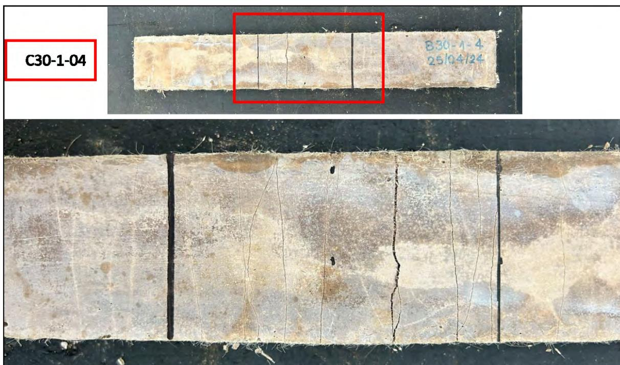
Figura 161 – Registro fotográfico – Ensaio de flexão do corpo de prova C30-1-04 (Fonte: A autora, 2024).
