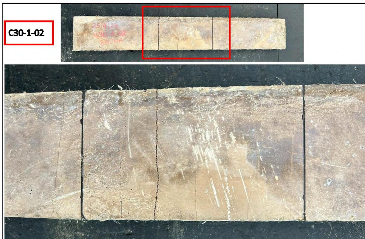
Figura 159 – Registro fotográfico – Ensaio de flexão do corpo de prova C30-1-02 (Fonte: A autora, 2024).
