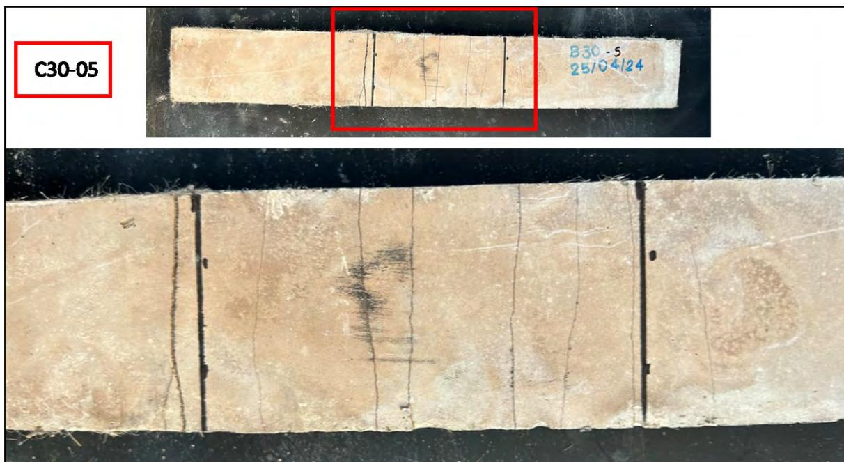
Figura 157 – Registro fotográfico – Ensaio de flexão do corpo de prova C30-05 (Fonte: A autora, 2024).
