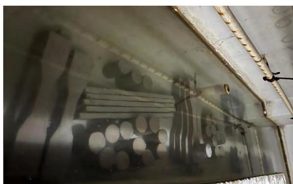
Figura 98 – Cura dos corpos de prova imersos em água (Fonte: A autora, 2024).
