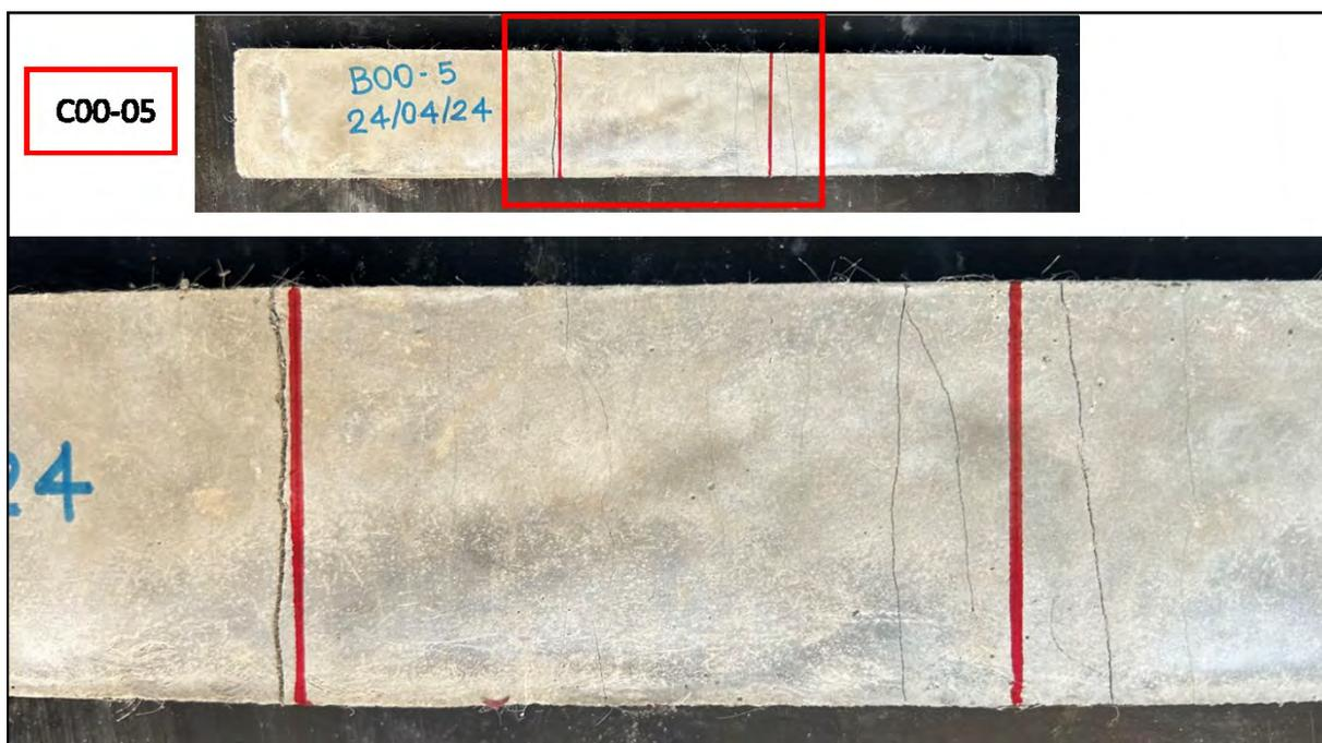
Figura 147 – Registro fotográfico – Ensaio de flexão do corpo de prova C00-05 (Fonte: A autora, 2024).
