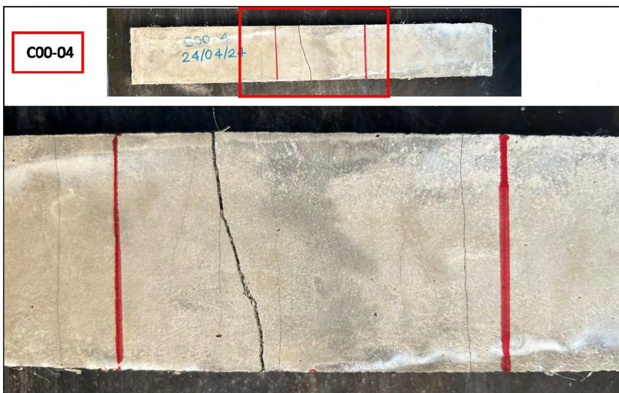
Figura 146 – Registro fotográfico – Ensaio de flexão do corpo de prova C00-04 (Fonte: A autora, 2024).
