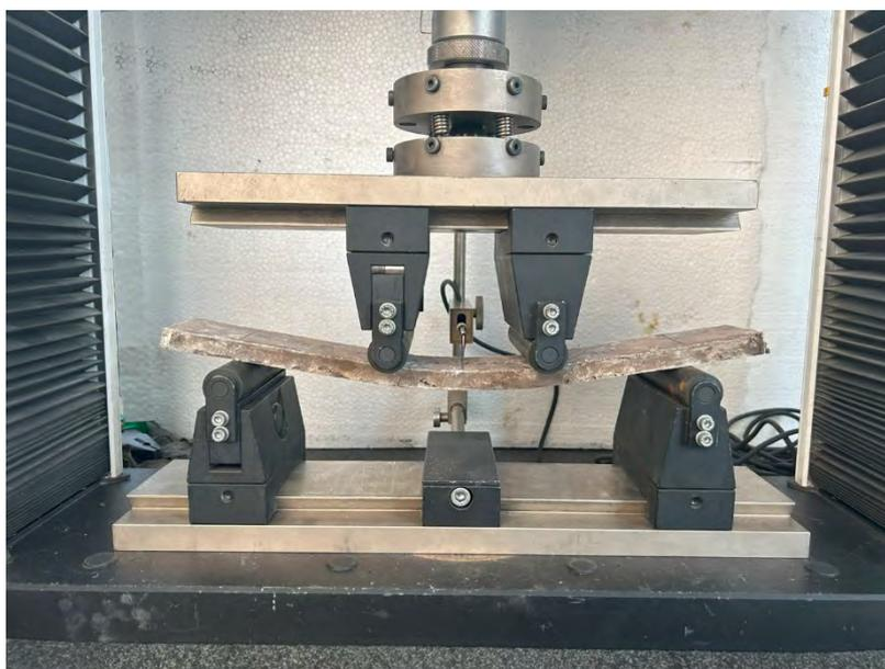
Figura 65 – Realização do ensaio de resistência à flexão da mistura de ECC com estéril (Fonte: A autora, 2024).
