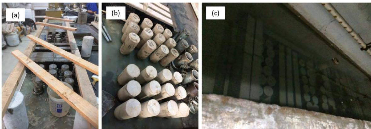
Figura 81 – (a) e (b) Primeiras 24 horas após a produção das misturas, sendo (a) preparação para a cura dos corpos de prova em ambiente úmido, (b) identificação dos corpos de prova e (c) cura dos corpos de prova imersos em água, após 24 horas até a data dos ensaios (Fonte: A autora, 2024).
