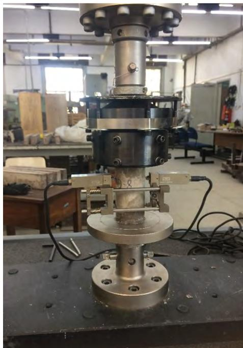
Figura 59 – Realização do ensaio de módulo de elasticidade (Fonte: A autora, 2024).
