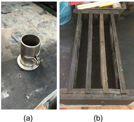
Figura 77 – Formas utilizadas para a produção dos corpos de prova: (a) cilíndrica e (b) retangulares (Fonte: A autora, 2024).
