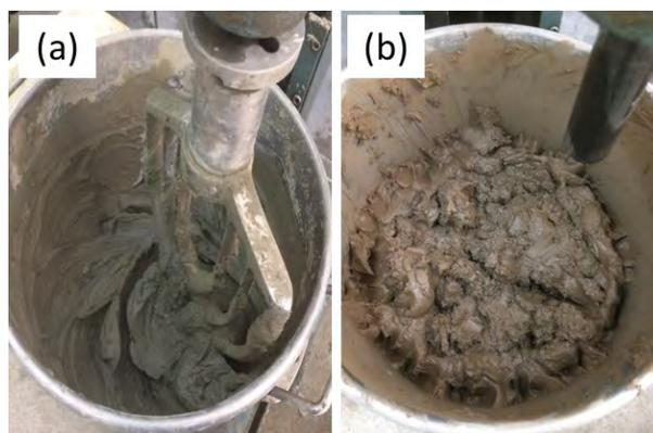
Figura 79 – Produção das misturas – Comparação das misturas de argamassa (a) sem e (b) com adição de 30% de estéril (Fonte: A autora, 2024).
