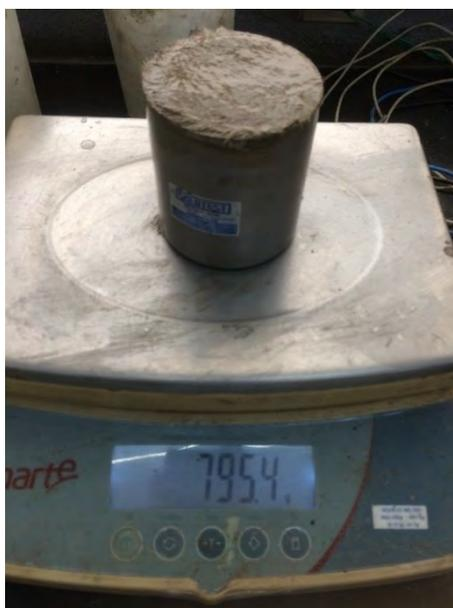
Figura 56 – Ensaio de massa específica da mistura de ECC com estéril (Fonte: A autora, 2024).
