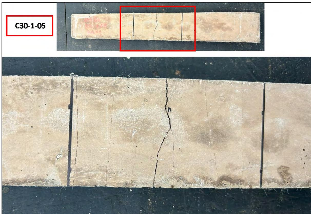
Figura 162 – Registro fotográfico – Ensaio de flexão do corpo de prova C30-1-05 (Fonte: A autora, 2024).
