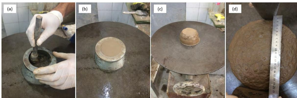
Figura 54 – Detalhes da execução do ensaio com a mistura de argamassa: (a) adensamento das camadas, (b) rasamento da mistura, (c) consistência da mistura após retirada do tronco cônico, e (d) espalhamento da mistura de argamassa com estéril (Fonte: A autora, 2024).
