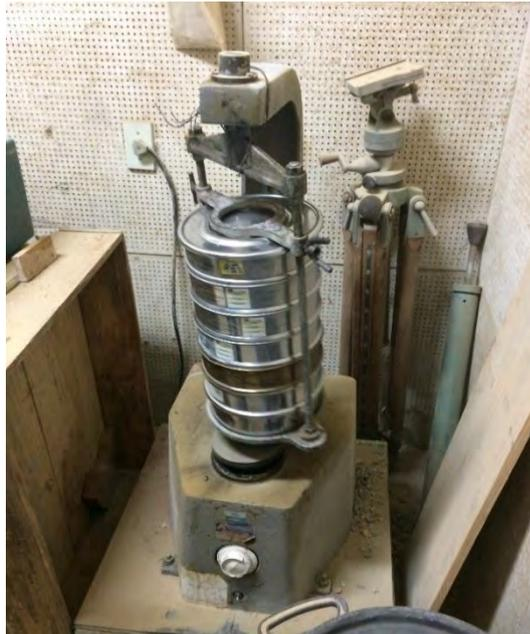
Figura 40 – Configuração do ensaio para determinação da curva granulométrica (Fonte: A autora, 2024).
