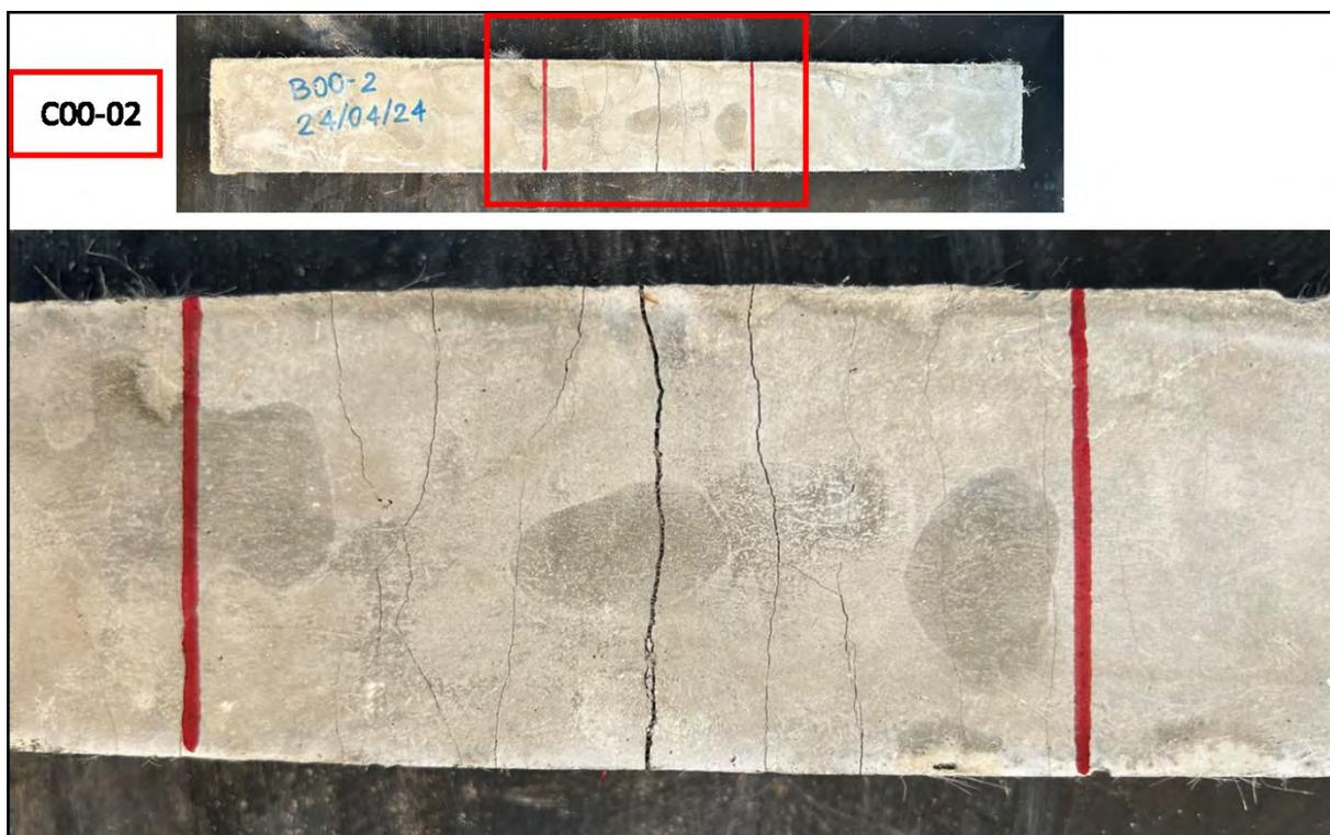
Figura 144 – Registro fotográfico – Ensaio de flexão do corpo de prova C00-02 (Fonte: A autora, 2024).
