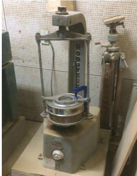
Figura 43 – Peneiramento para realização do ensaio de índice de finura do cimento (Fonte: A autora, 2024).
