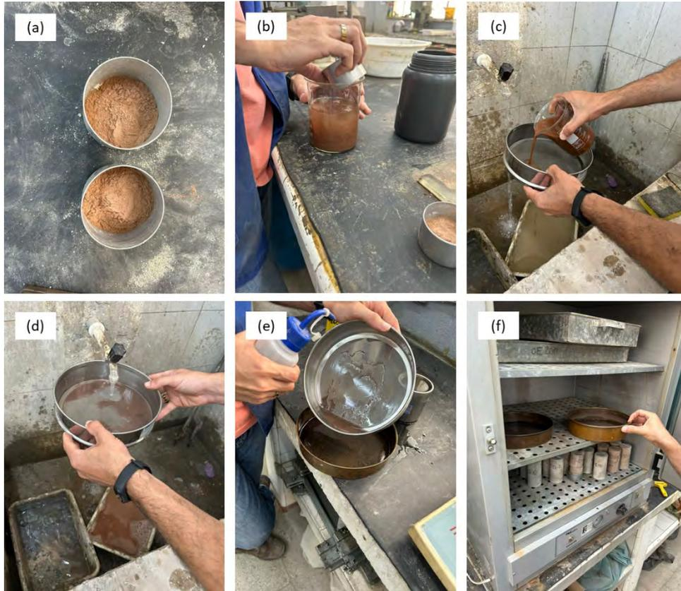
Figura 42 – Etapas para determinação do módulo de finura do estéril, sendo (a) separação das amostras, (b) transferência das amostras para solução de hexametáfosfato de sódio, (c) colocação da mistura na peneira, (d) colocação da peneira sob fluxo de água, (e) transferência do material com auxílio de pisseta de água e (f) colocação do material em estufa (Fonte: A autora, 2024).
