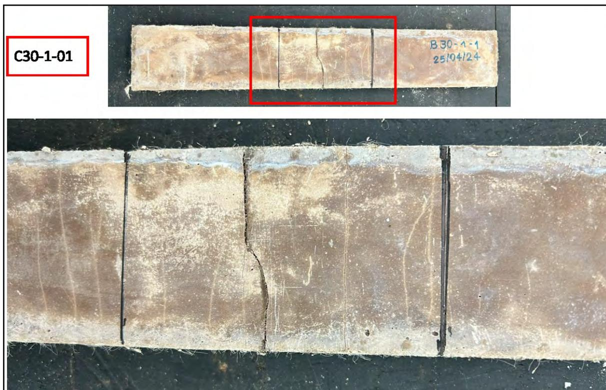
Figura 158 – Registro fotográfico – Ensaio de flexão do corpo de prova C30-1-01 (Fonte: A autora, 2024).
