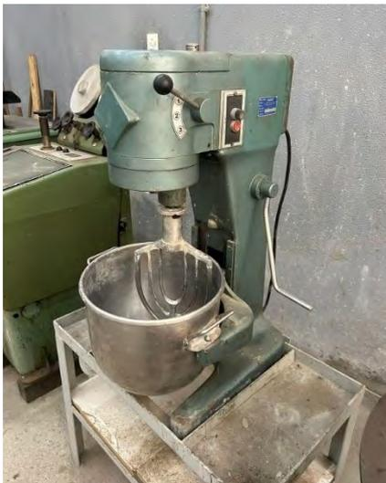
Figura 78 – Argamassadeira utilizada para a produção das misturas de argamassa e de ECC (Fonte: A autora, 2024).
