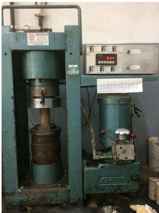
Figura 58 – Realização dos ensaios de resistência à compressão com o equipamento Forney (Fonte: A autora, 2024).
