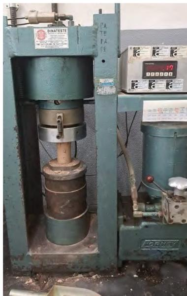
Figura 51 – Realização do ensaio de atividade pozolânica com a cal (Fonte: A autora, 2024).
