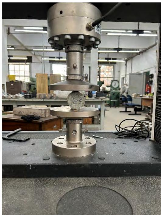
Figura 61 – Realização do ensaio de resistência à tração por compressão diametral (Fonte: A autora, 2024).
