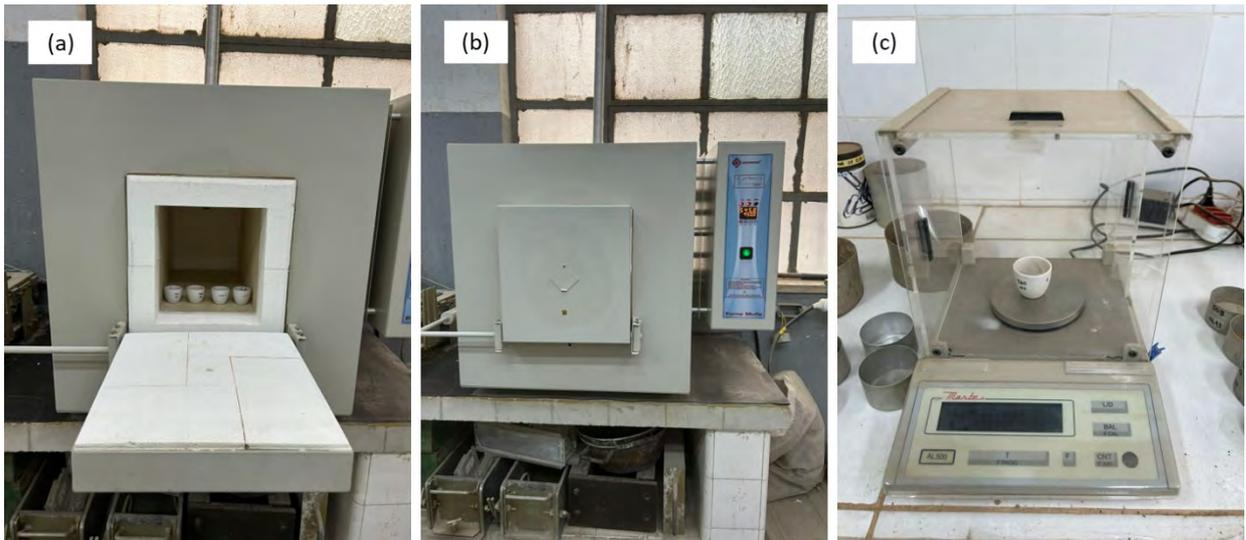
Figura 49 – Realização do ensaio de perda ao fogo, sendo (a) colocação das amostras no forno, (b) aquecimento das amostras e (c) pesagem da amostra (Fonte: A autora, 2024).
