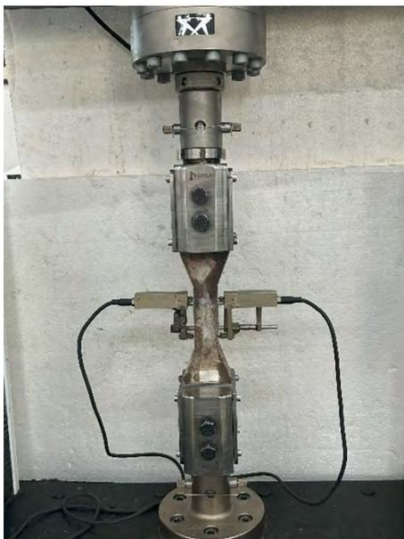
Figura 63 – Realização do ensaio de resistência à tração da mistura de ECC com estéril
