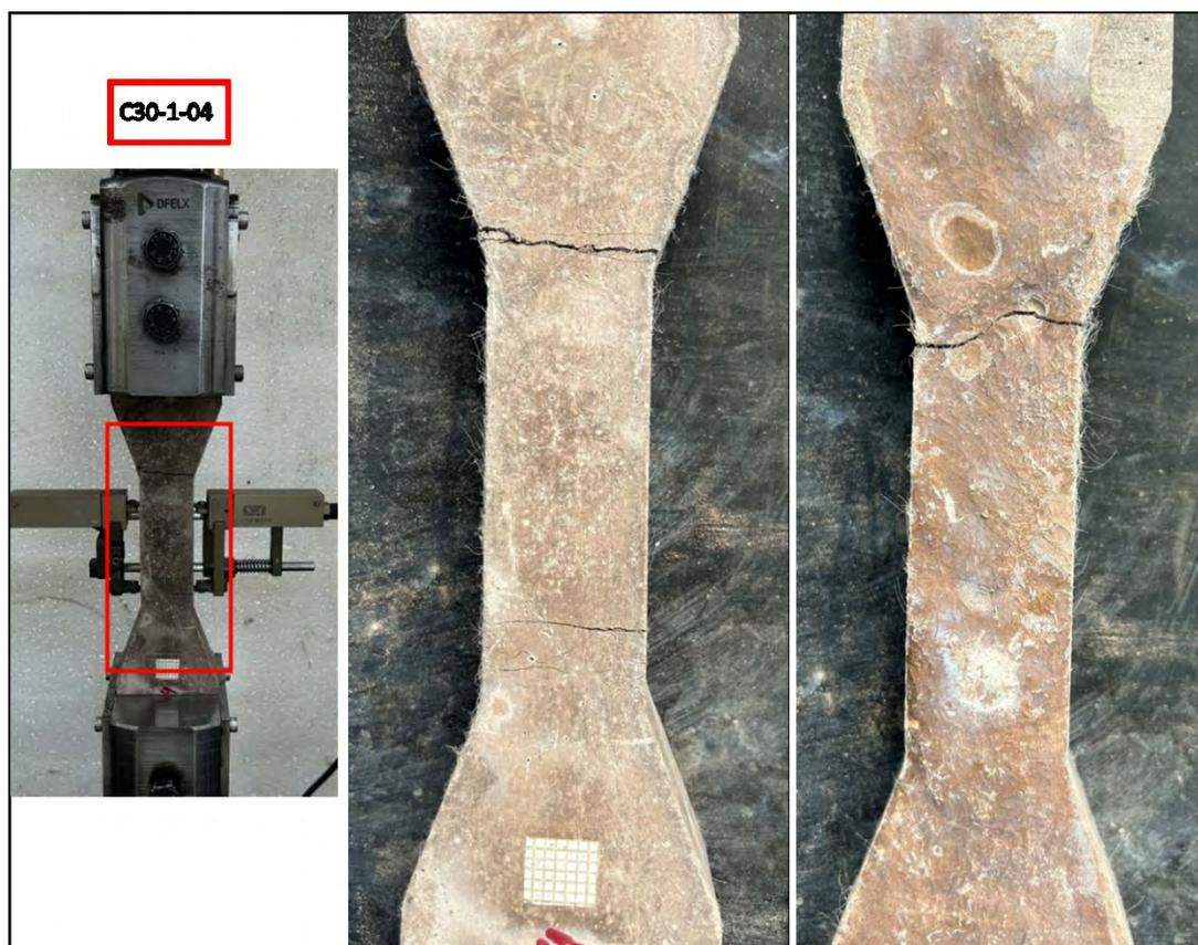
Figura 141 – Registro fotográfico – Ensaio de tração direta do corpo de prova C30-1-04
