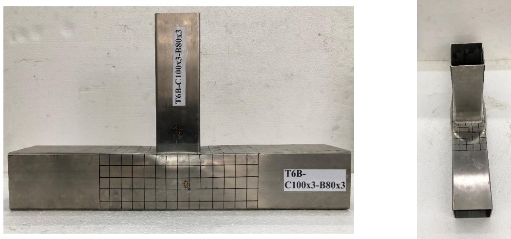
Figura 66 – T6B-C100x3-B80x3 após ensaio
