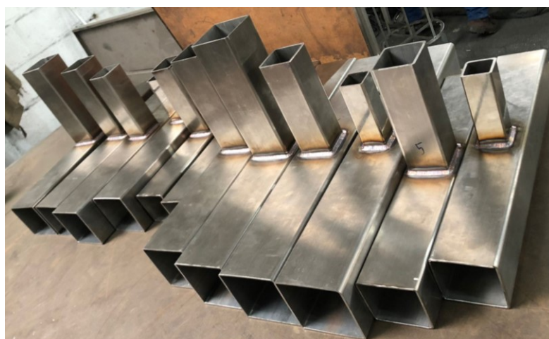
Figura 35 – Ligações após soldagem
