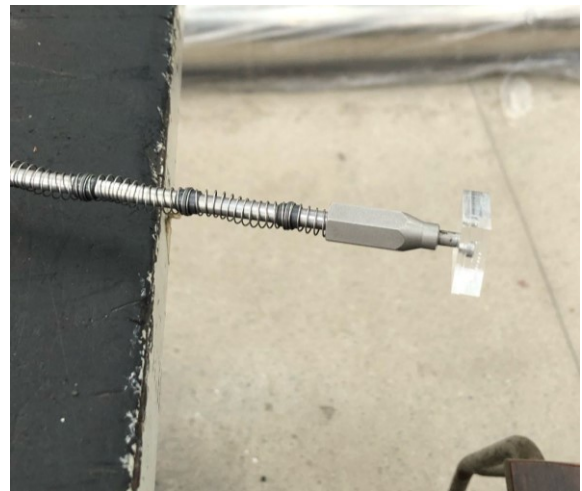
b) Acrílico para LVDTs da face lateral
