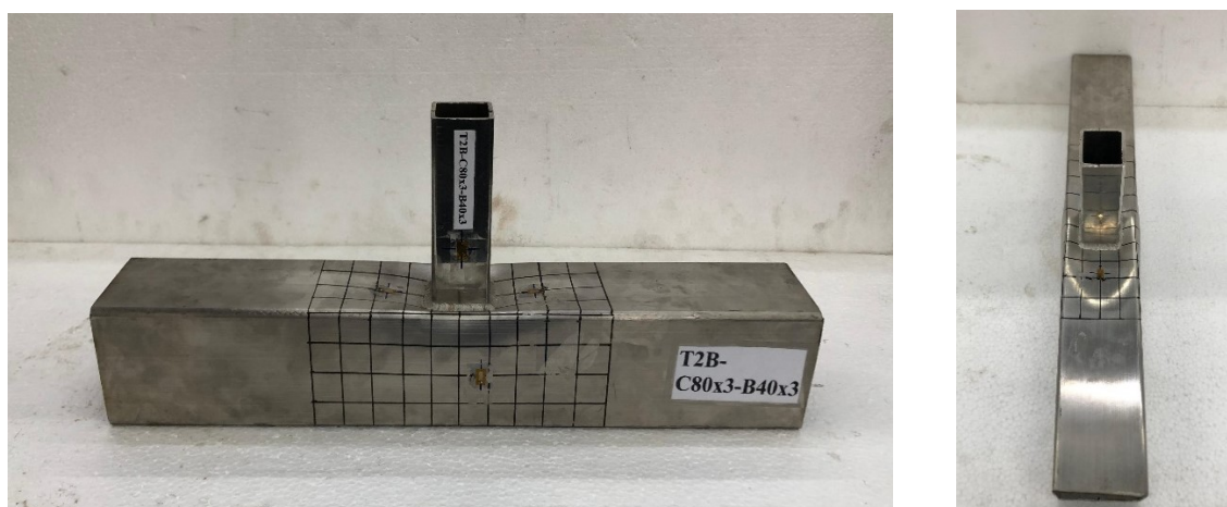
Figura 50 – T2B-C80x3-B40x3 após ensaio
