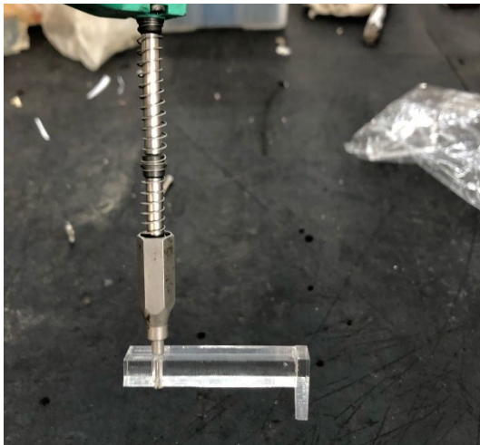
a) Acrílico para LVDTs da face superior
