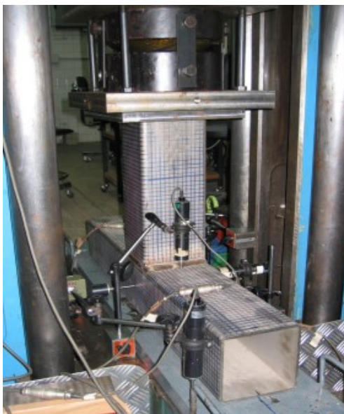
Figura 16 – Ligação utilizada nos ensaios de Feng e Young [70]
