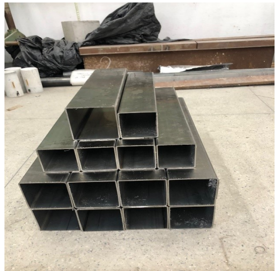
d) Perfis após fresagem
