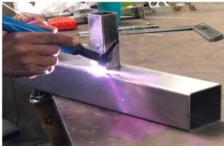
Figura 34 – Soldagem entre perfis da ligação
