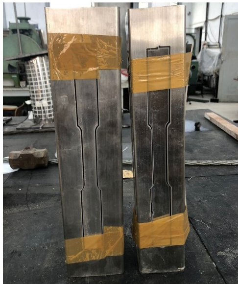
Figura 26 – Posição de extração dos corpos de prova
