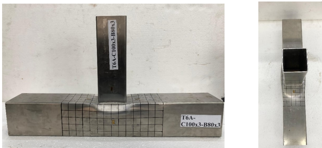
Figura 65 – T6A-C100x3-B80x3 após ensaio
