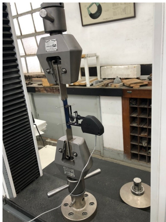
b) Fixação do corpo de prova
