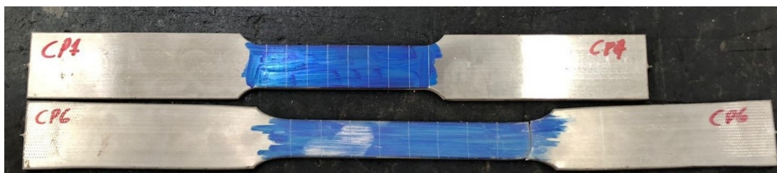
Figura 29 – Comparação de alongamento após ensaio de tração
