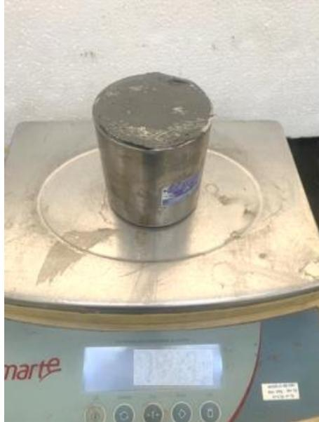
Figura 34 – Pesagem da mistura fresca no ensaio de massa específica.
