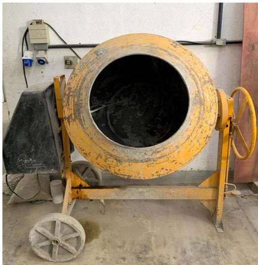
Figura 63 – Betoneira utilizada na concretagem.
