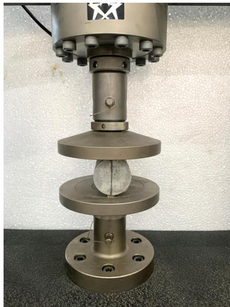
Figura 37 – Ensaio de compressão diametral.
