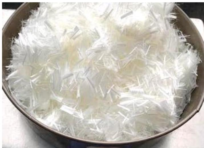
Figura 23 – Fibra de PVA utilizada na composição do SHCC.
