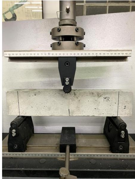
Figura 38 – Configuração do ensaio de tenacidade à fratura da matriz do SHCC.
