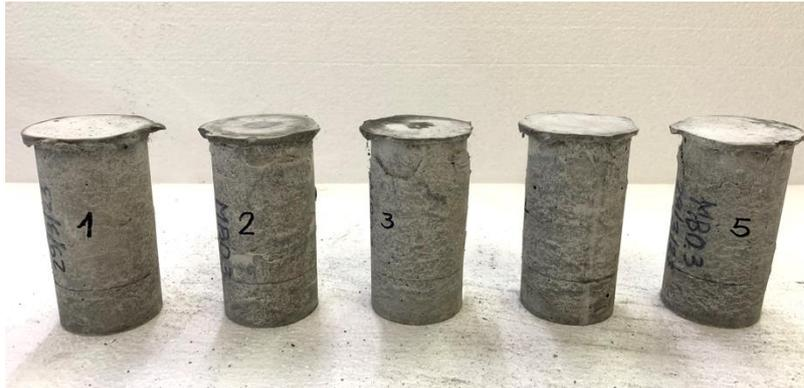
Figura 36 – Corpos de prova capeados.
