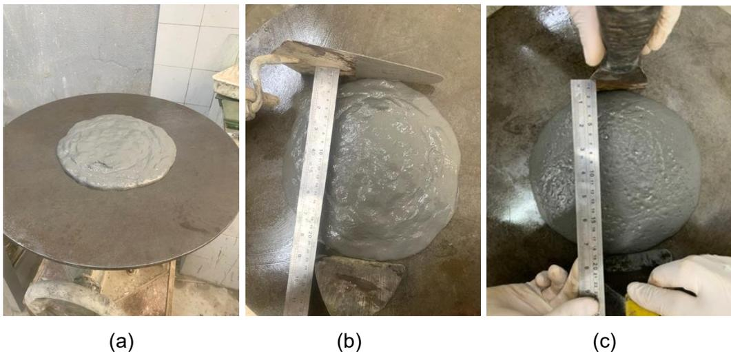
Figura 33 – (a) Ensaio de consistência do compósito do tipo SHCC, (b) medindo o espalhamento do SHCC e (c) medindo o espalhamento da matriz.
