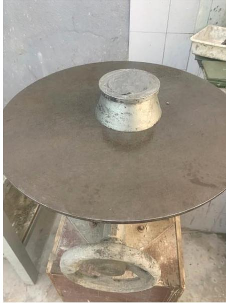
Figura 32 – Mesa com o molde tronco cônico.
