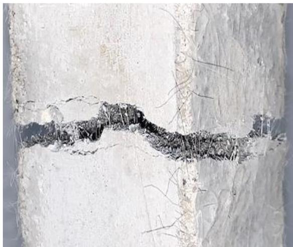
Figura 56 – Detalhe da fissura principal do corpo de prova de tração.
