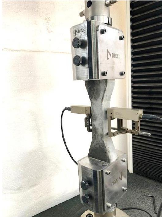
Figura 41 – Dispositivo e corpo de prova para ensaio de tração com extensômetro.
