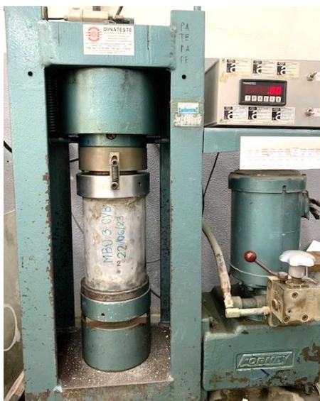
Figura 70 – Ensaio de compressão axial no CP de 15 x 20 cm reforçado com SHCC.
