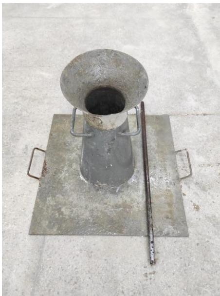
Figura 67 – Equipamentos para o ensaio de consistência no concreto.
