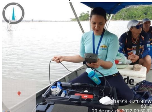
Figura 26 - Medição de parâmetros físico-químicos In situ com sonda multiparamétrica
