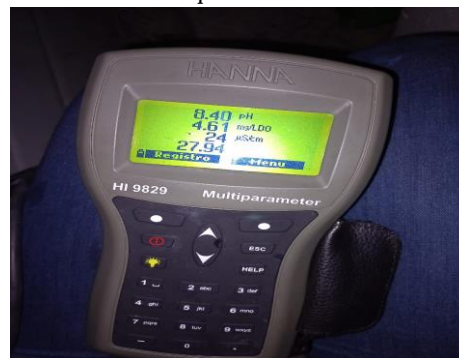
Figura 27 - Registro fotográfico dos resultados dos parâmetros físico-químicos medidos In Situ
