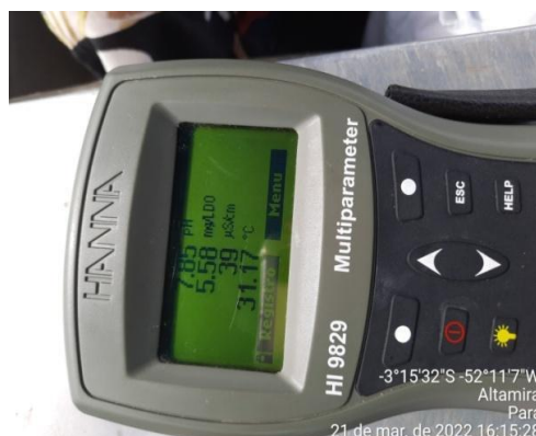
Foto 18 – AR_01_09TR Registro fotográfico dos resultados dos parâmetros físico-químicos medidos In Situ
