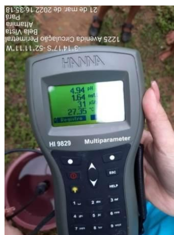
Foto 20 – AR_01_10PÇ Registro fotográfico dos resultados dos parâmetros físico-químicos medidos In Situ
