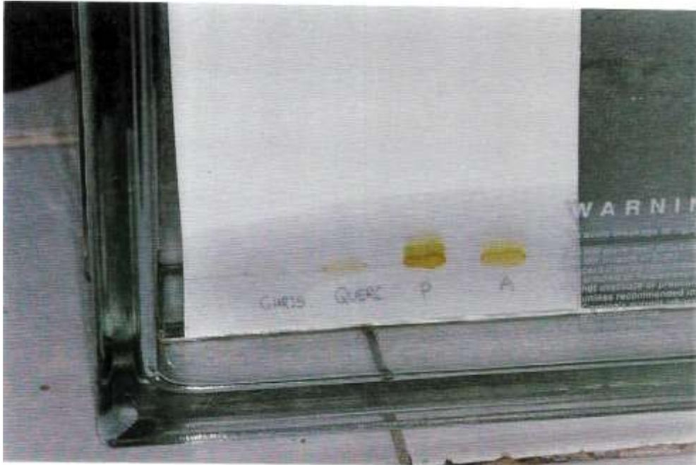
Figura 3: Cuba e placa cromatográficas.
