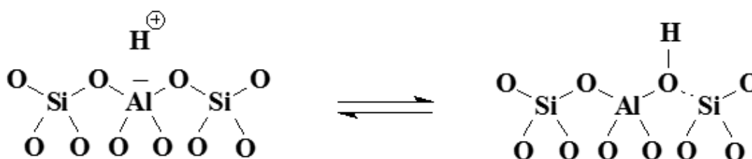
Figura 6 – Sítio ácido de Brønsted presente nas zeólitas
