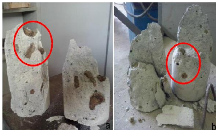
Figura 14 – Corpos de provas rompidos após ensaio de resistência à compressão axial
