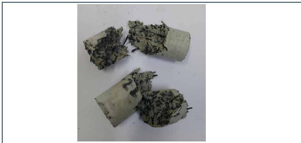
Figura 21– Corpos de prova de compressão/densidade fabricados em molde de borracha de silicone, pós ensaio de compressão
