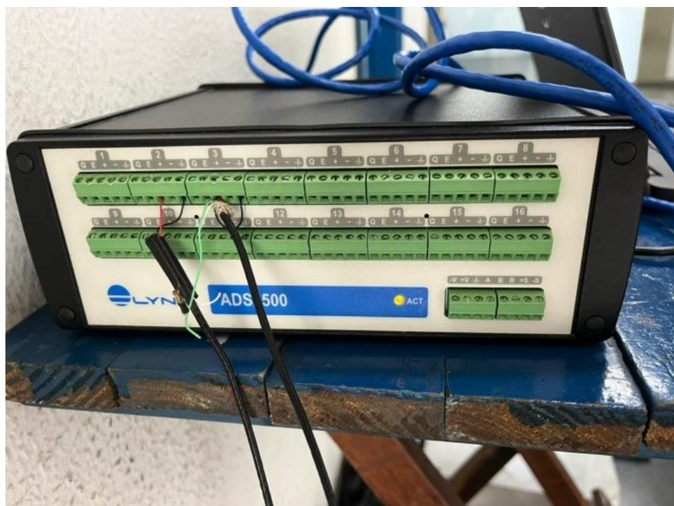
(b) ADS 2500 com os acelerômetros acoplados
