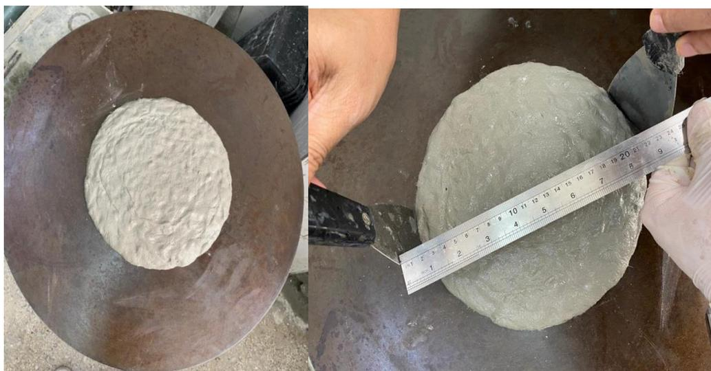
Figura 31 – Medida do índice de consistência dos compósitos.
