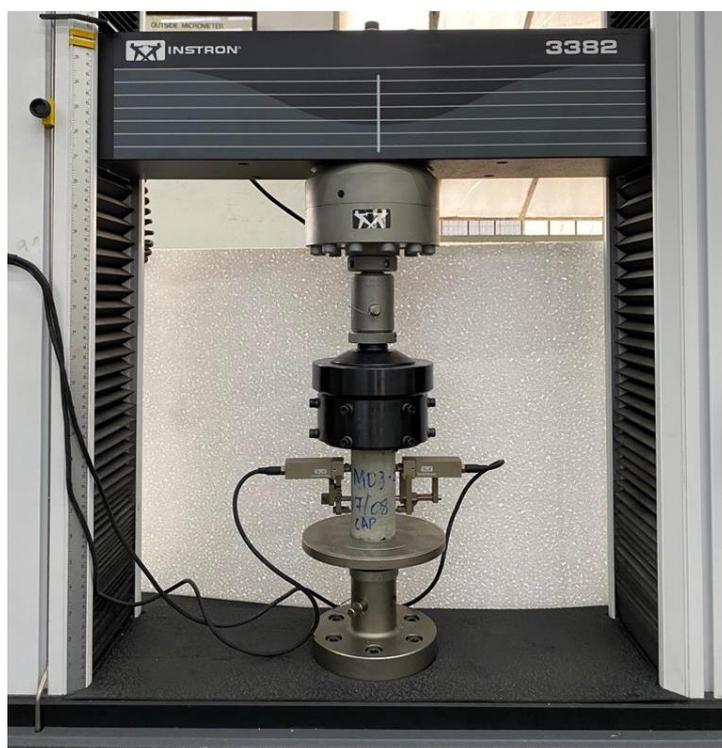
Figura 33 – Configuração dos ensaios de compressão dos compósitos.
