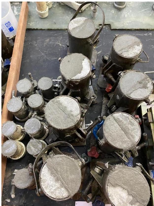
Figura 24 – Formas cilíndricas preenchidas com os concretos reparados.
