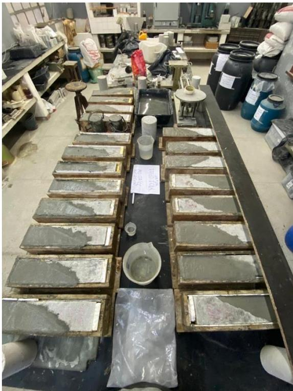
Figura 23 – Formas prismáticas preenchidas com o concreto reparado.
