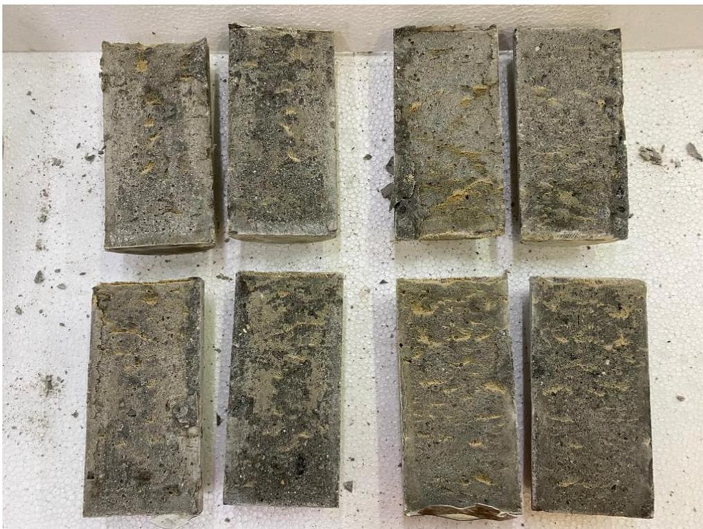
Figura 66 – Ruptura dos corpos de prova reparados da mistura M02S1 com presença de adesivo sintético.
