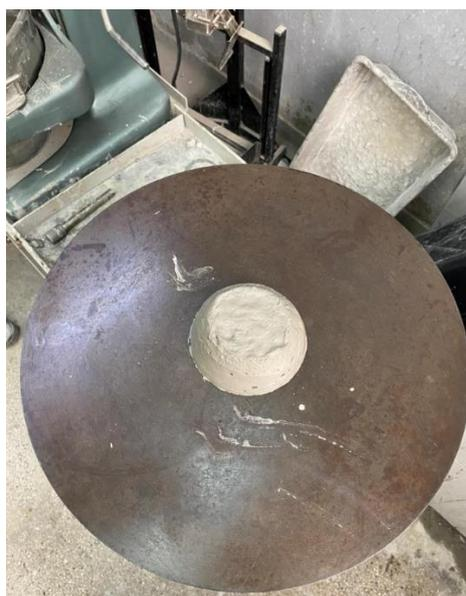
Figura 30 – Argamassa após retirada de molde tronco cônico
