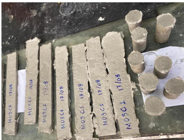
Figura 18 – Corpos de prova de flexão e compressão desmoldados
