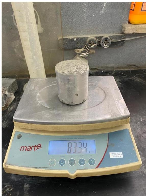
Figura 32 – Ensaio de massa específica no estado fresco
