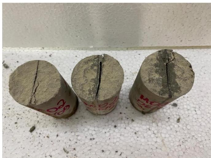
Figura 60 – Rompimento dos corpos de prova de compressão diametral.
