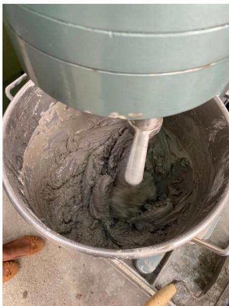
Figura 16 - Mistura dos ingredientes na argamassadeira.
