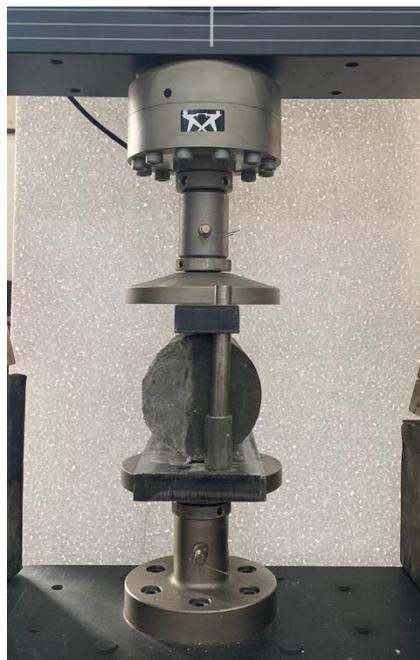
Figura 37 – Ensaio de compressão diametral do conjunto reparado.
