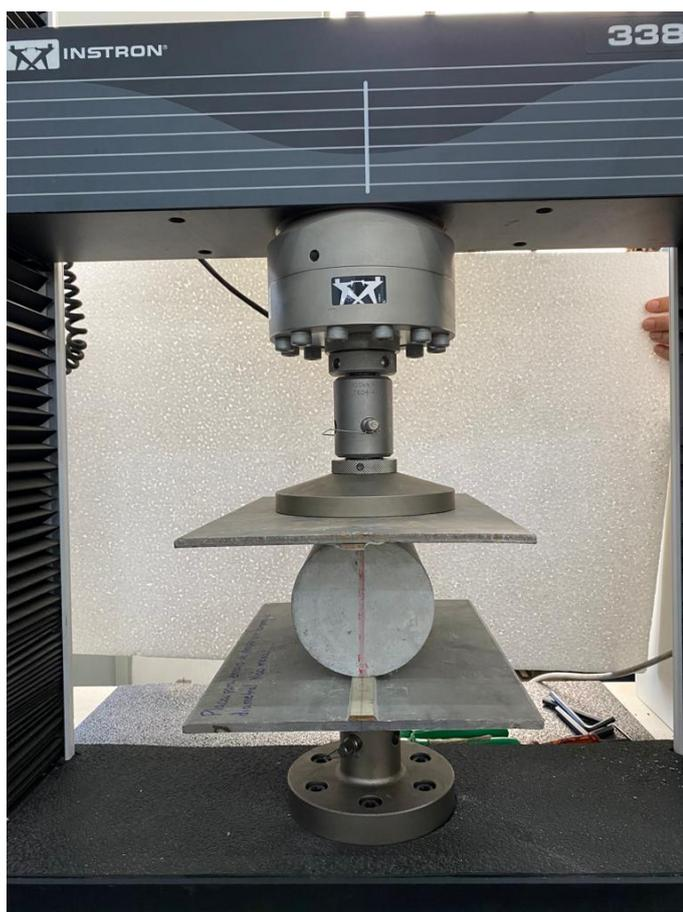
Figura 29 – Ensaio de tração por compressão diametral.
