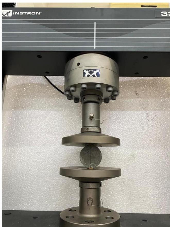
Figura 35 – Ensaio de compressão diametral da argamassa
