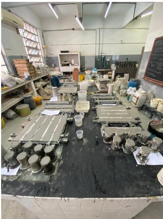
Figura 17 – Moldagem de corpos de prova para caracterização dos compósitos.
