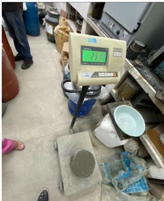
Figura 26 – Ensaio de massa específica do concreto fresco
