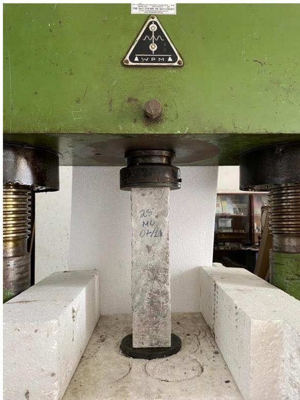
Figura 38 – Prensa hidráulica utilizada no ensaio de cisalhamento oblíquo.
