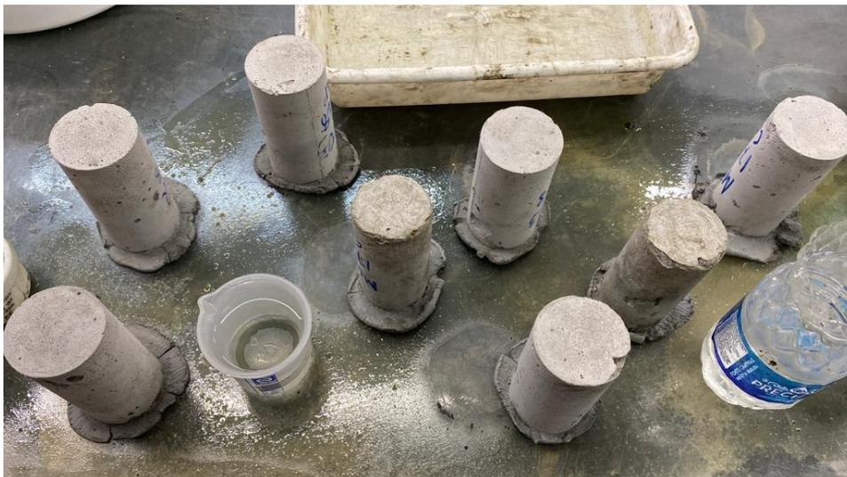
Figura 34 – Capeamento de corpos de prova de compressão.
