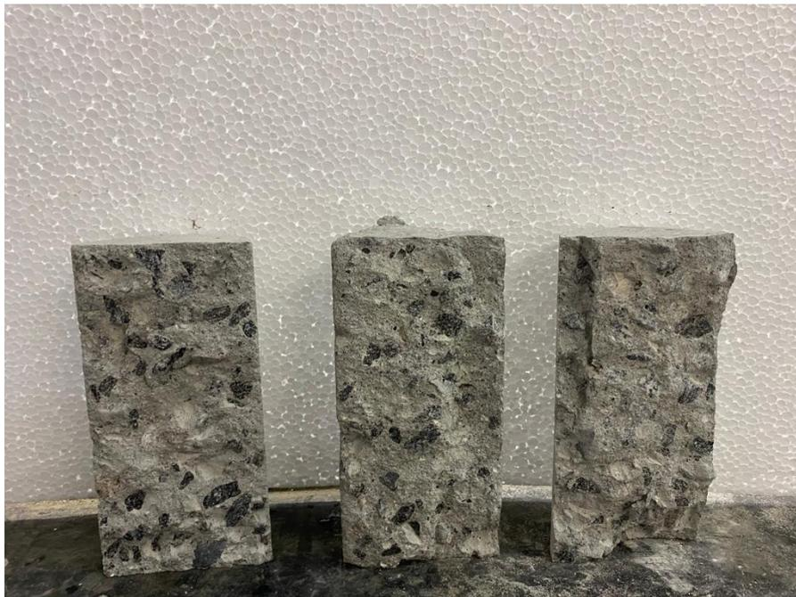
Figura 61 – Aspecto da ruptura dos corpos de prova de concreto
