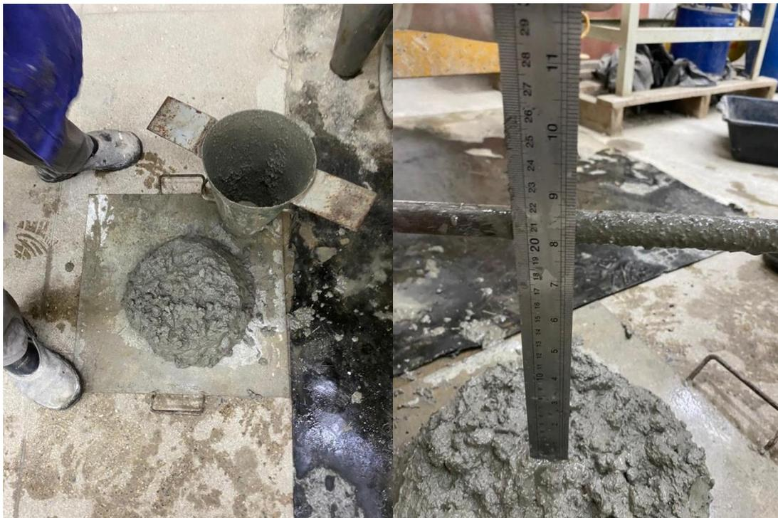
Figura 25 – Medição do abatimento do tronco de cone
