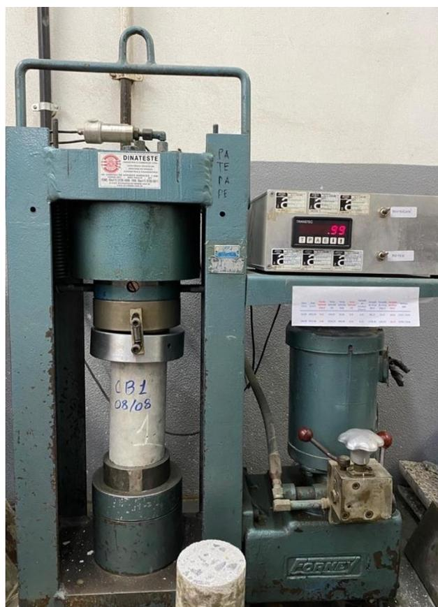
Figura 27 – Configuração do ensaio de resistência à compressão no concreto.
