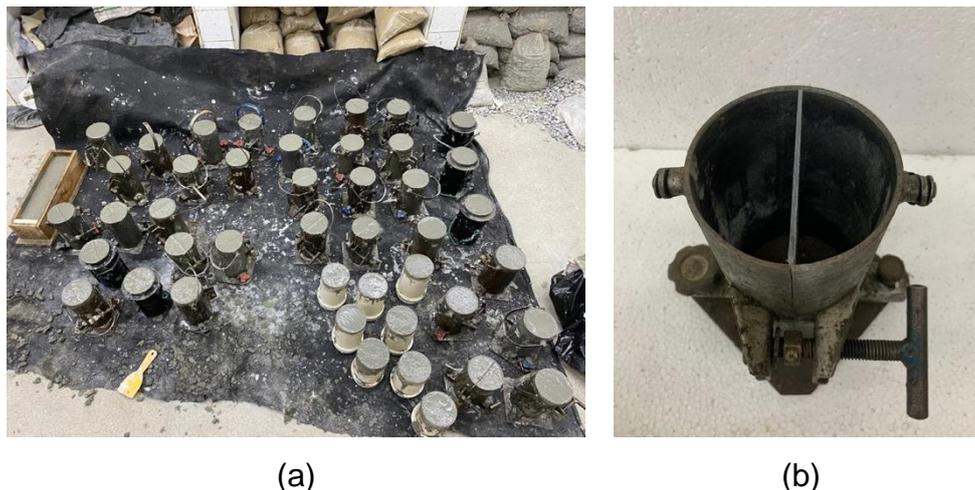
Figura 10 – (a) Moldagem do concreto de base e (b) Forma de aço adaptada para o ensaio de compressão diametral do composto (concreto-reparo).
