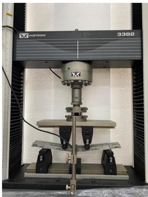
Figura 36 – Ensaio de flexão de 4 pontos nos compósitos.
