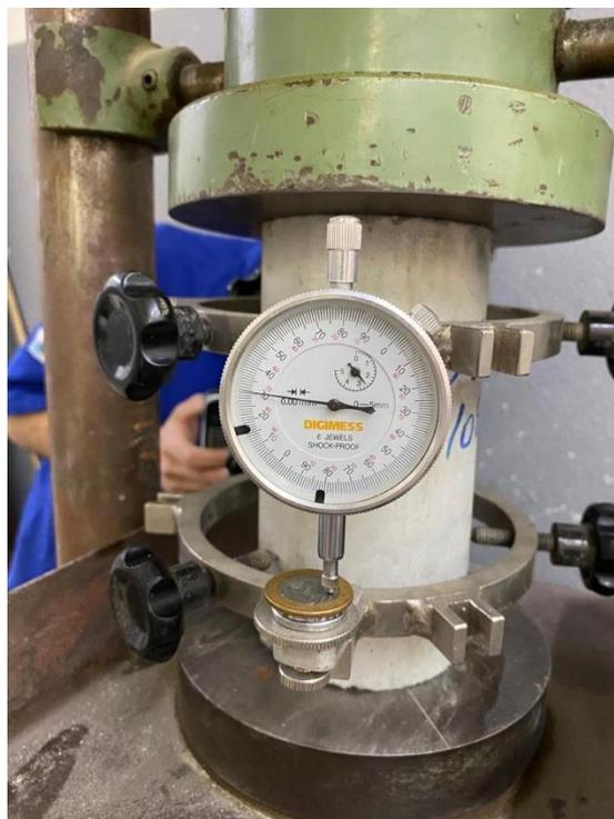
Figura 28 – Configuração utilizada no ensaio de módulo de elasticidade do concreto.
