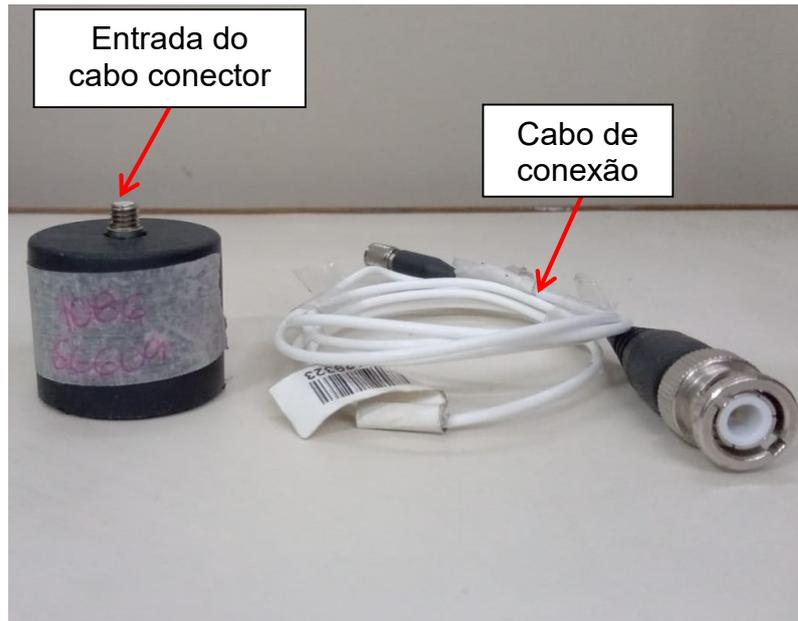
Figura 35 - Acelerômetro PCB Pieztronics e cabo de conexão
