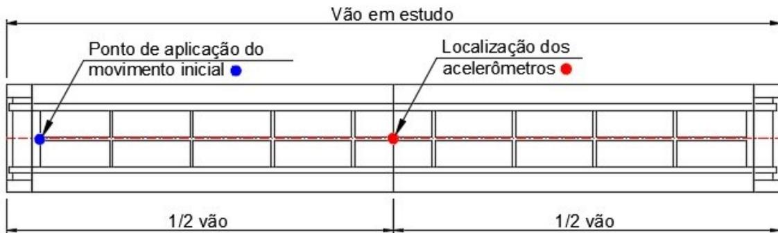
Figura 71 - Seção de análise da estrutura
