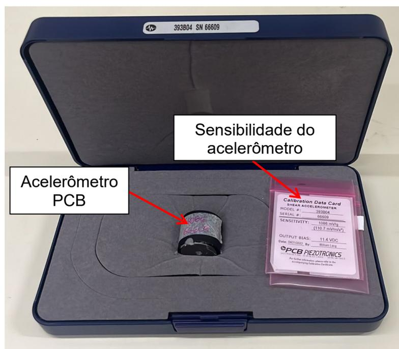
Figura 34 - Acelerômetro PCB Piezotronics
