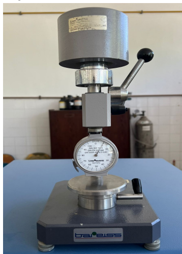
Figura 16 - Durômetro Shore D - GS702.
