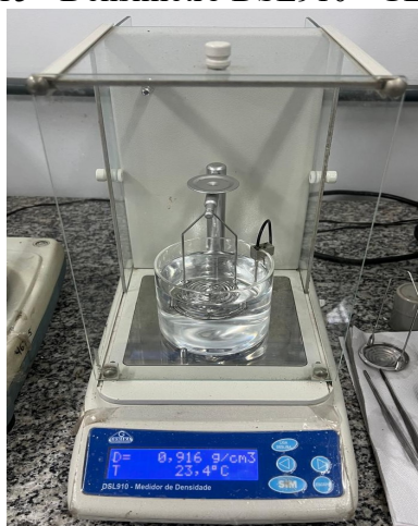
Figura 15 - Densímetro DSL910 - GEHAKA.
