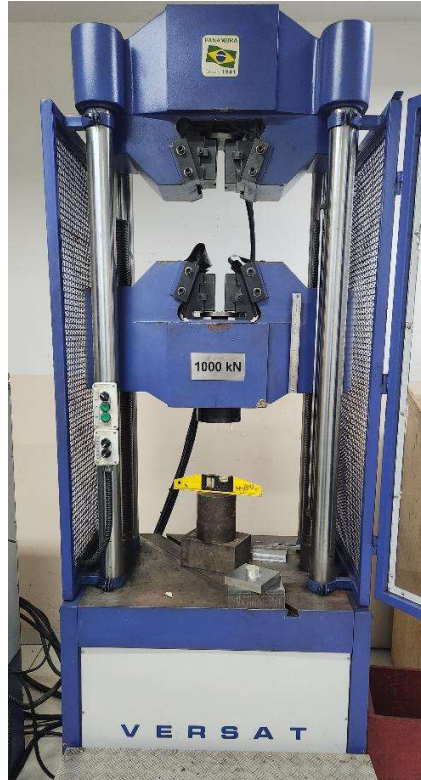
Figura 30: Máquina utilizada no ensaio de compressão da prata esterlina (925) - prensa PANAMBRA.
