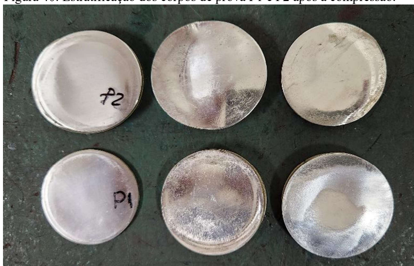
Figura 40: Estratificação dos corpos de prova P1 e P2 após a compressão.
