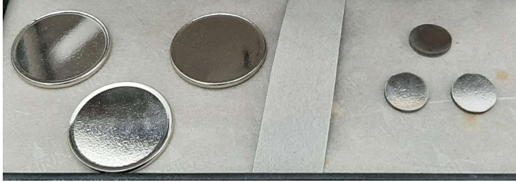
Figura 26: Disco de cuproníquel ( \text{Cu}_{75}\text{Ni}_{25} ) orlado e sem orla.
