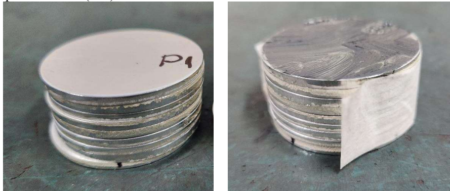
Figura 32: Exemplificação do uso de fita para fixação e centralização dos discos de prata esterlina (925).
