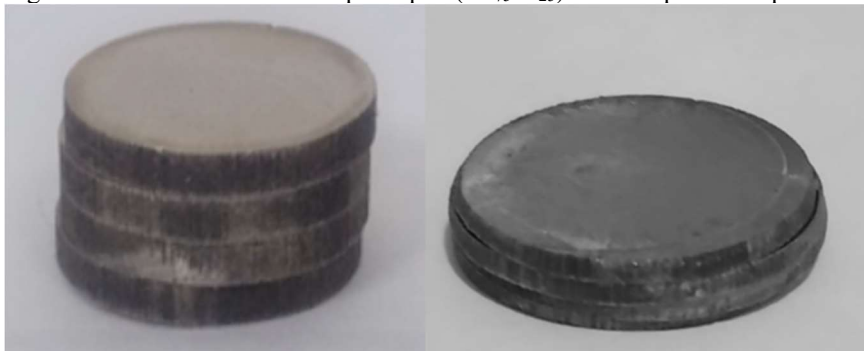
Figura 43: Pilha de discos de cuproníquel ( \text{Cu}_{75}\text{Ni}_{25} ) antes e após a compressão.
