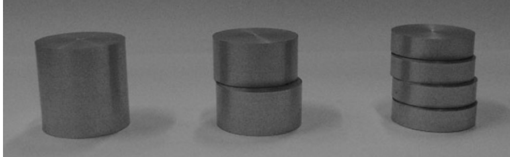
Figura 21: Forma inicial de corpos de prova fabricados em liga de alumínio AA-2011.
