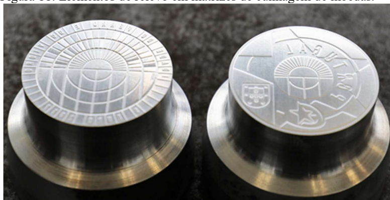
Figura 11: Elementos de relevo em matrizes de cunhagem de moedas.
