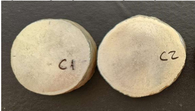
Figura 39: Corpos de prova C1 e C2 após a compressão.
