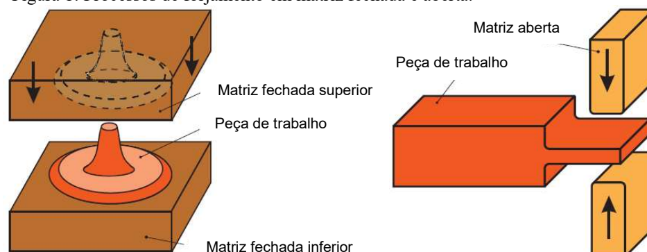
Figura 1: Processos de forjamento em matriz fechada e aberta.
