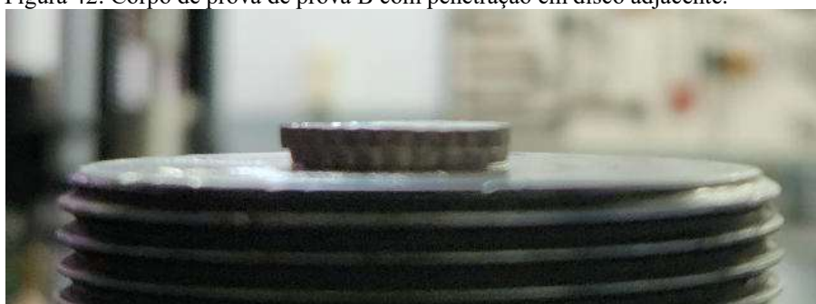
Figura 42: Corpo de prova de prova B com penetração em disco adjacente.
