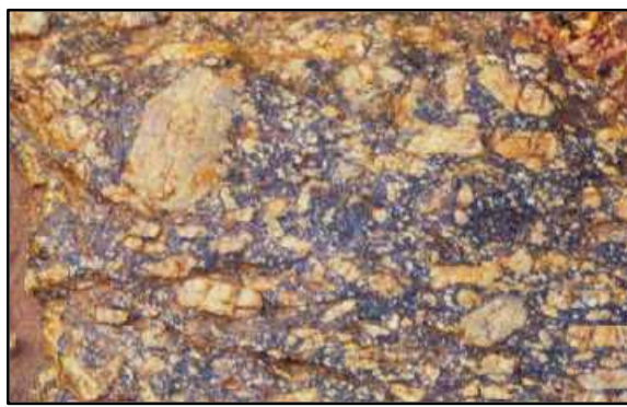
Figura 7 – Foto exemplificando a textura porfirítica observada no Granito Serra do Lagarto, próximo à Passa Vinte.
