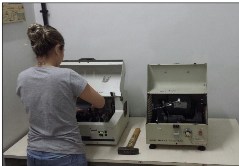
Figura 3 - Foto da preparação das amostras tanto para Litogeoquímica quanto para geoquímica isotópica – Moinho de bolas (LGPA).
