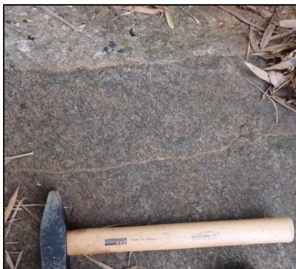
Figura 14 - Contato entre o hornblenda biotita granito porfirítico e o Granulito do Complexo Juiz de Fora. Ponto MI-BL-17.
