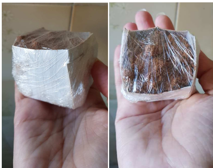
Figura 63 - Uma das amostras indeformadas, protegidas pela caixa em papel cartão e o plástico filme.
