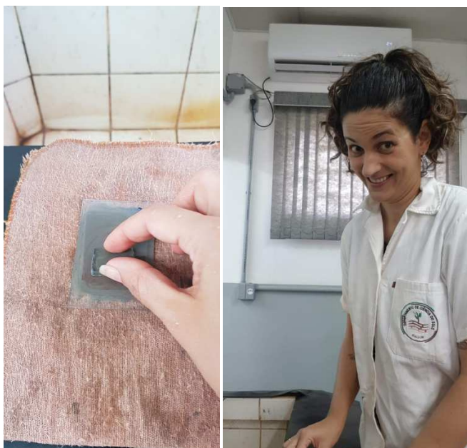
Figura 67 - Polimento da lâmina com peça abrasiva.
