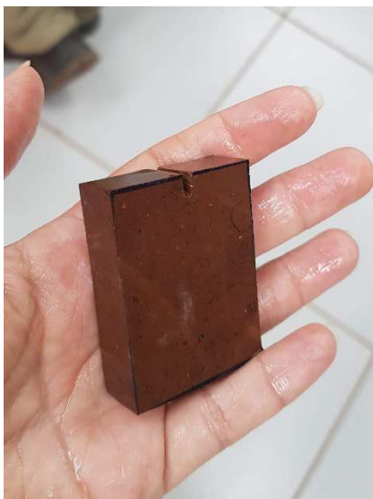
Figura 66 - Corte e polimento de um dos blocos usados.
