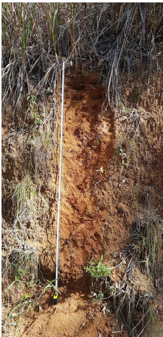
Figura 41 - Abertura e limpeza de perfil no ponto 5 para identificação, descrição e coleta de amostras.
