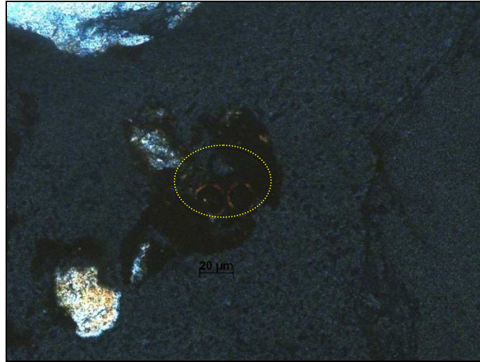
Figura 32 - Revestimento de argila fortemente contínua e orientada
