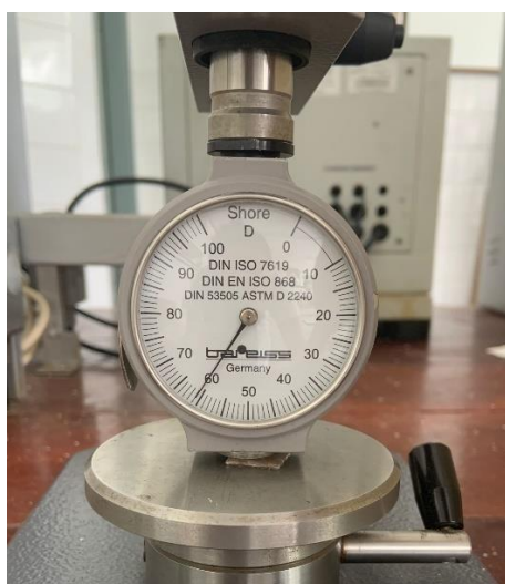
Figura 21 - Durômetro Shore D Bareiss BS61 II
