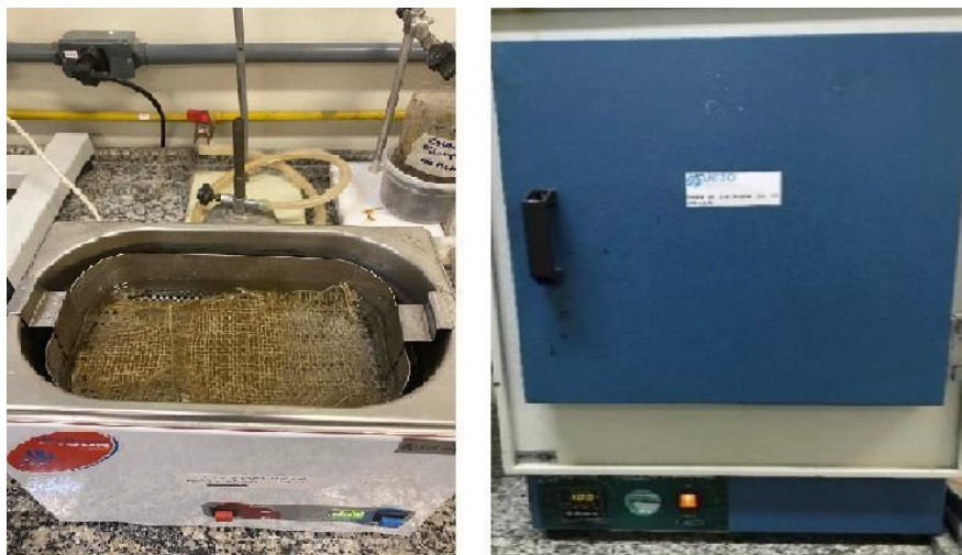
Figura 11 - (a) Tela de sisal imersa em banho de ultrassom e (b) Estufa esterilização de secagem Marconi MA 033/5
