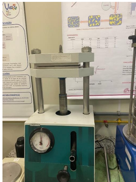
Figura 16 - Prensa à frio MARCONI MA 098/A
