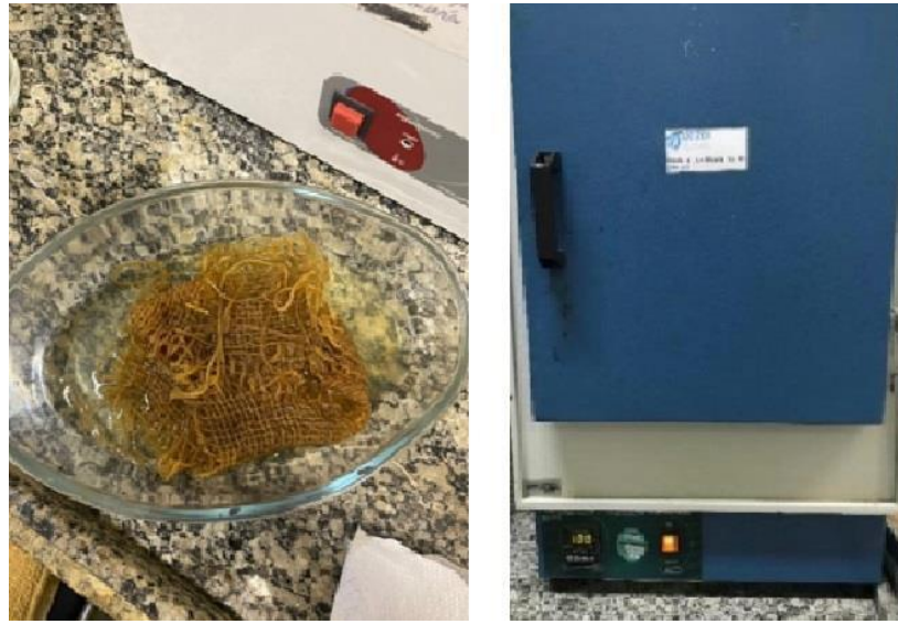
Figura 10 - (a)Tela de sisal tratada com NaOH (b) Estufa de esterilização e secagem Marconi MA 033/5
