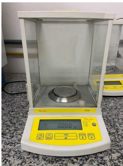
Figura 23 - Balança analítica da marca Marte, Modelo AY220
