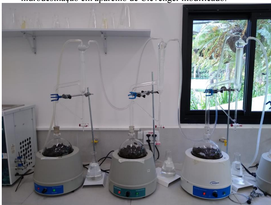
Figura 13 – Extração dos óleos essenciais foliares de Piper richardiifolium por hidrodestilação em aparelho de Clevenger modificado.
