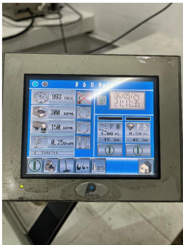
Figura 30: Parâmetros determinados para o procedimento de polimento.
