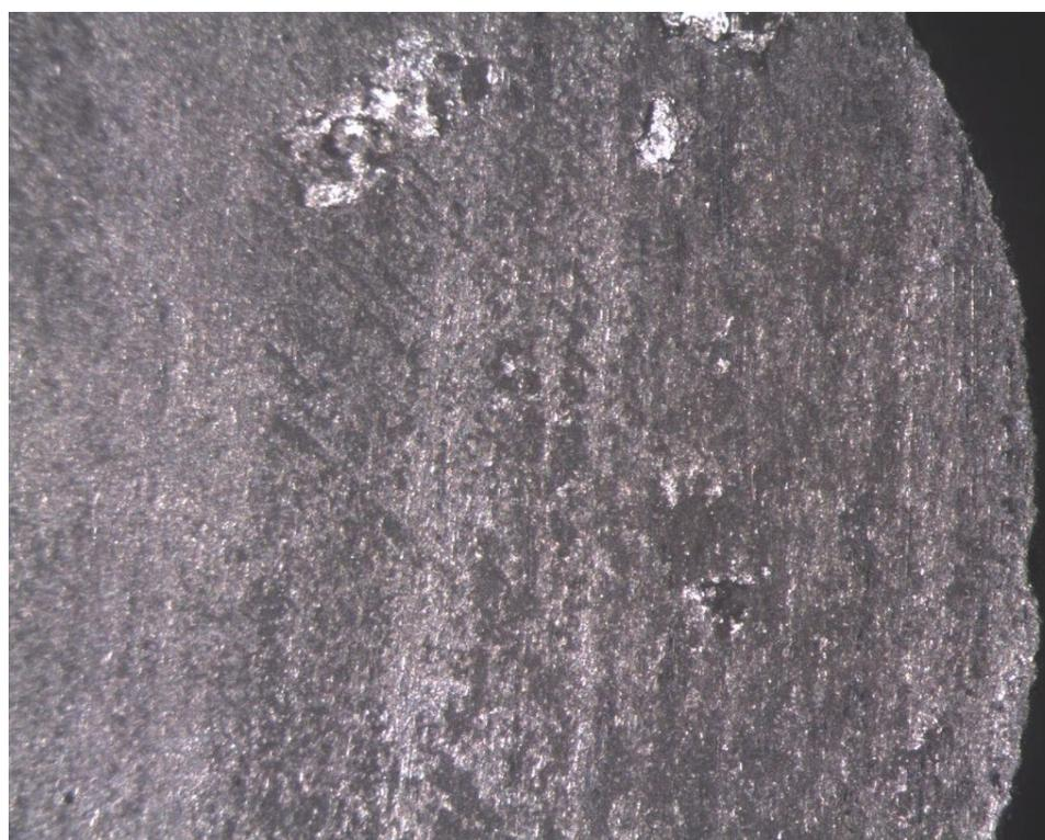
Figura 136: Imagem MO da amostra C2. Morfologia da superfície de desgaste, com magnificação de 4x, após ensaio de desgaste pino-sobre-disco.
