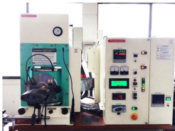
Figura 28. Equipamento *Spark Plasma Sintering*. Adaptado de (TRINDADE, 2020).
