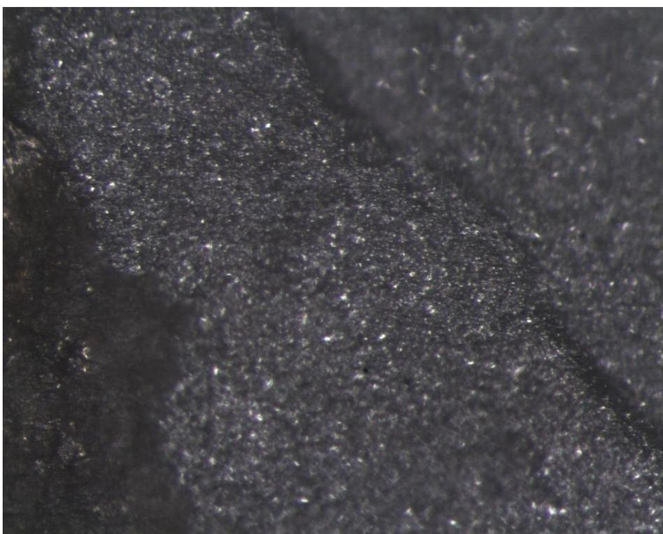
Figura 132: Imagem MO da amostra B2, magnificação de 10x, após ensaio de desgaste pino-sobre-disco.
