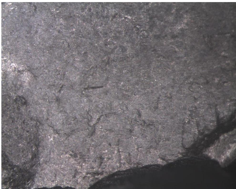
Figura 138: Imagem MO da amostra C6. Morfologia da superfície de desgaste, com magnificação de 4x, após ensaio de desgaste pino-sobre-disco.
