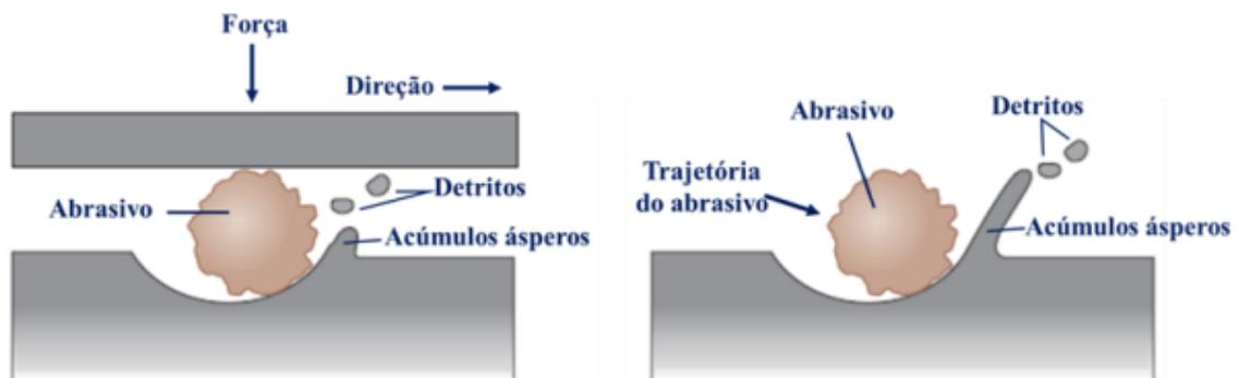
Figura 21 – O desgaste abrasivo, causado por abrasivos aprisionados ou livres. Fonte – Askeland et al., 2010, p. 880
