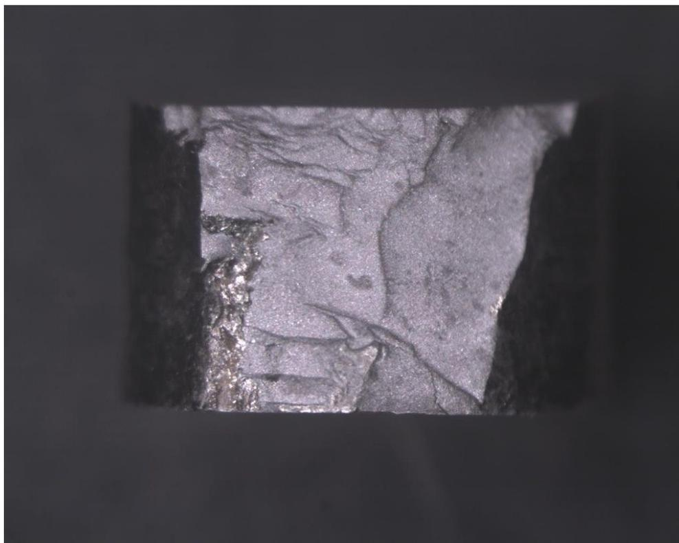
Figura 133: Imagem MO da amostra B6, em vista lateral da superfície fraturada durante ensaio de desgaste pino-sobre-disco, com magnificação de 1,25x.
