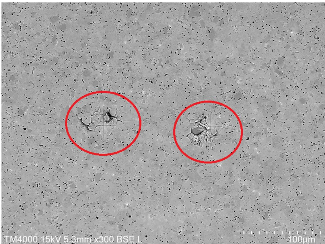
Figura 101: Região da amostra C1 coletada em modo campo (BSE) mostrando a forma como a indentação fragmentou a amostra.
