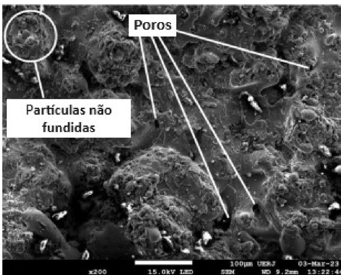
Figura 104: Imagem de MEV da morfologia da superfície revestida.
