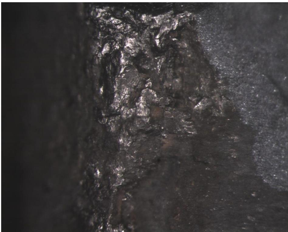
Figura 131: Imagem MO da amostra B2, magnificação de 4x, após ensaio de desgaste pino-sobre-disco.
