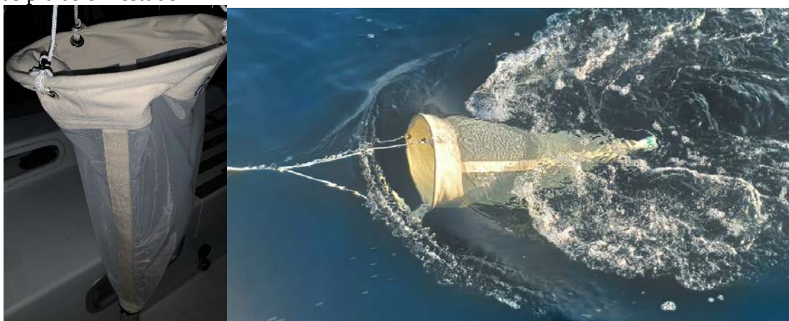
Figura 34 – Rede de coleta de 60 micrometros para coleta das amostras das águas costeiras das praias em estudo
