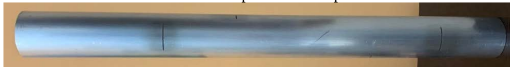
Figura 27 – Amostrador metálico cilíndrico para coleta de profundidade de sedimentos
