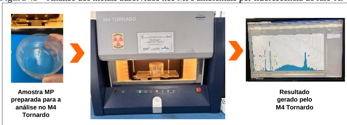
Figura 43 – Análise dos metais adsorvidos nos MPs ambientais por fluorescência de raio-X.
