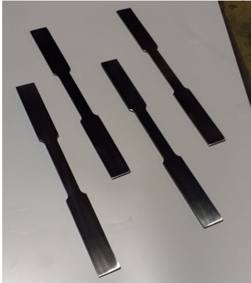
Figura 44 – Corpos-de-prova antes do ensaio de tração
