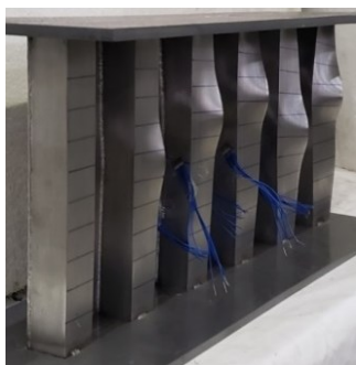
Figura 84 – Deformadas experimental e numérica – Painel 2
