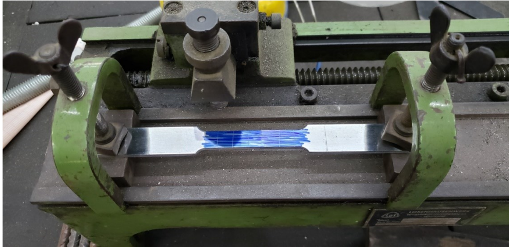
Figura 46 – Marcação de ranhuras na superfície dos corpos-de-prova
