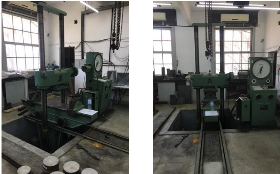
Figura 40 – Prensa hidráulica Lousenhausenwerk disponível para os ensaios
