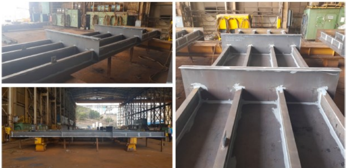
Figura 22 – Painéis enrijecidos nos quais foram medidas as tensões residuais biaxiais [34]
