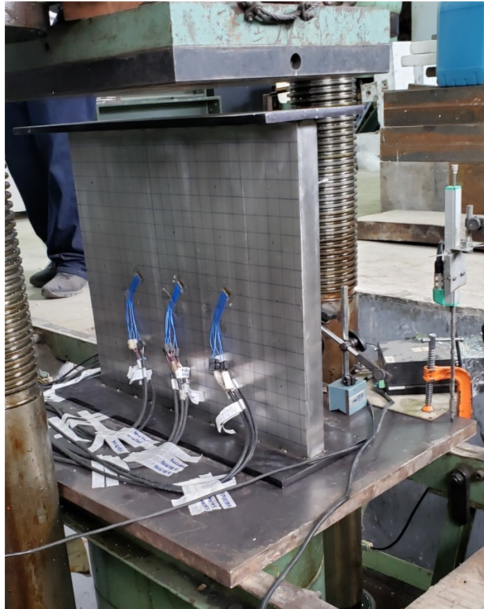
Figura 57 – LVDTs e strain gauges – Vista posterior - Painei 1
