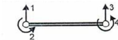
**Figura 3 – Graus de liberdade de viga à flexão, (Filho, 2002)**
