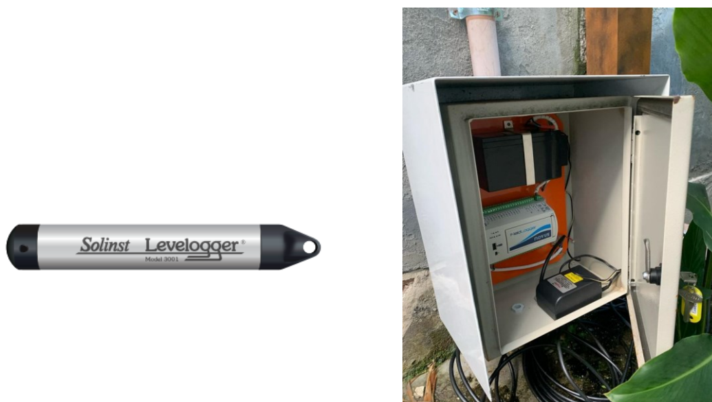
Figura 26 - Linígrafos para medição de nível d'água armazenado no jardim de chuva.
