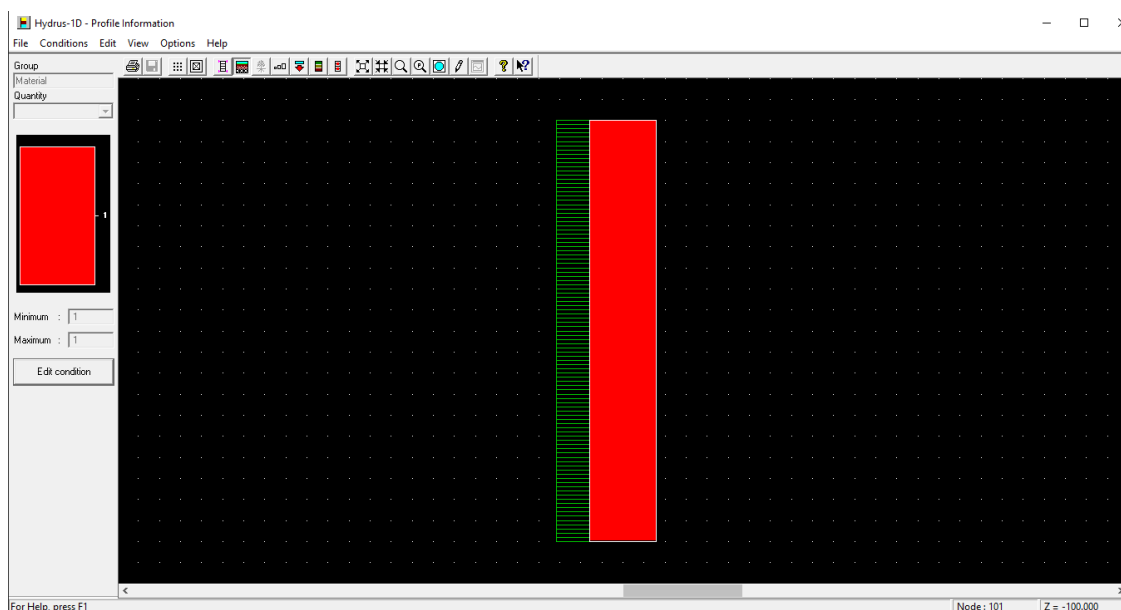
Figura 27 - Interface do Hydrus-1D apresentando o perfil discretizado em 100 intervalos.
