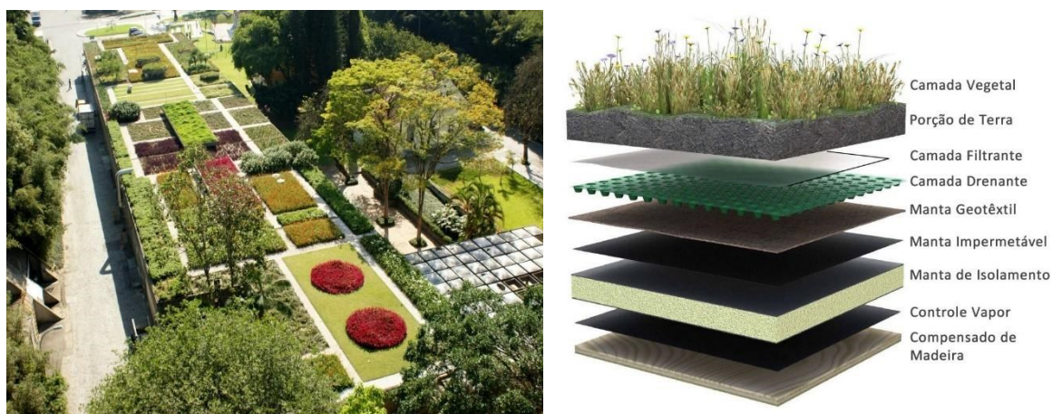
Figura 6 - Exemplo de telhado verde implantado no Brasil e composição de camadas da estrutura padrão.
