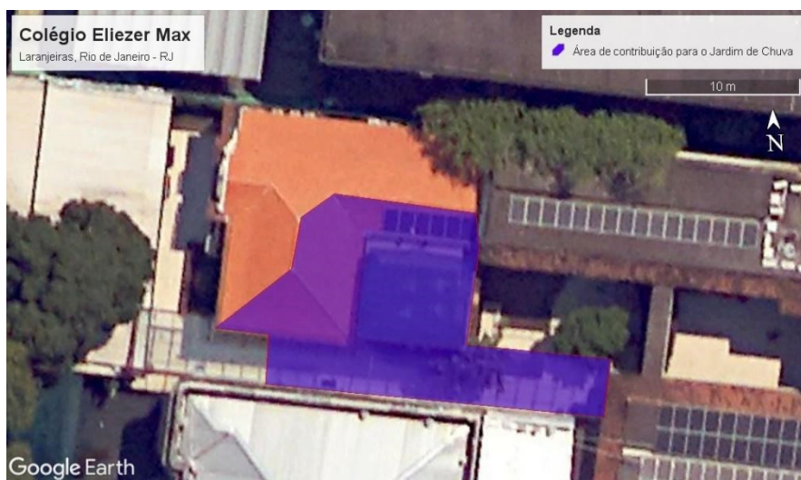
Figura 22 - Área de contribuição para o jardim de Chuva instalado no Colégio Eliezer Max, Rio de Janeiro, RJ.
