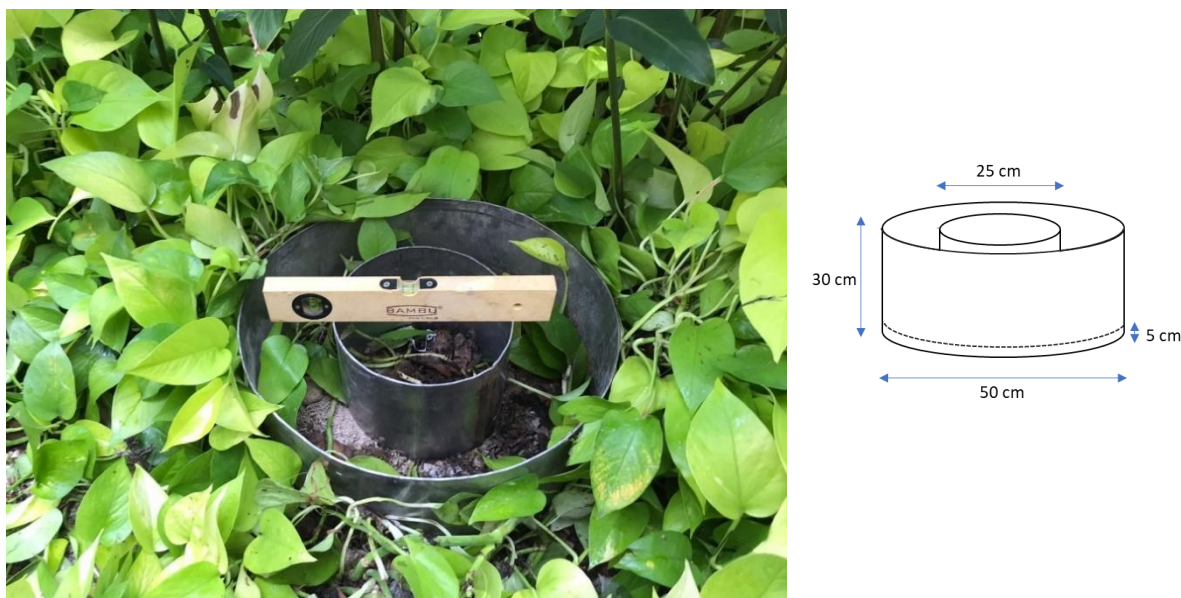
Figura 24 - Ensaio de anéis concêntricos realizado no jardim de chuva do Colégio Eliezer Max.
