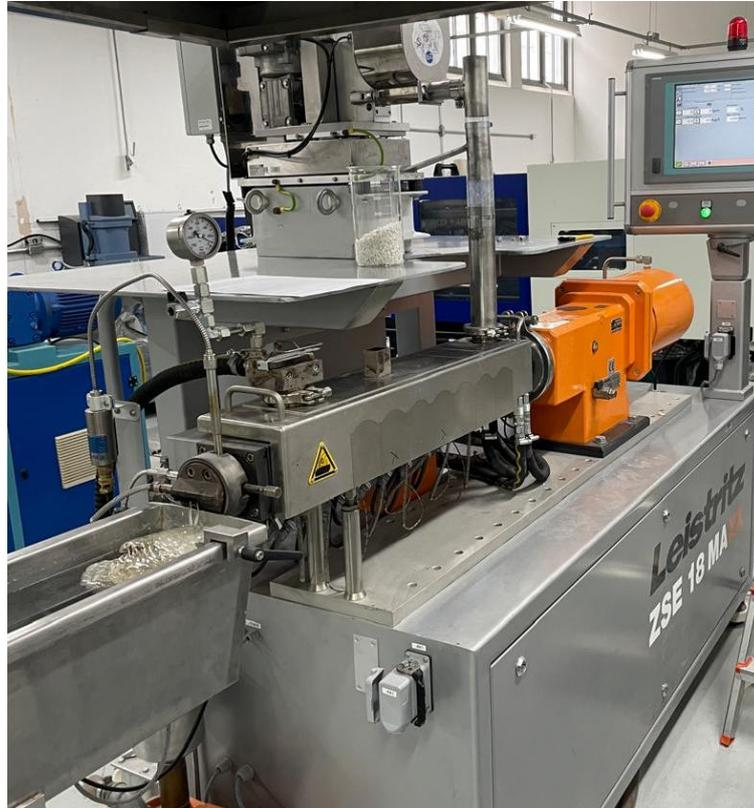
**Figura 13 - Extrusora de rosca dupla que será utilizada para a preparação das diferentes composições de PA e óxido de grafeno reduzido, Laboratório TECPOL (IPRJ/UERJ), departamento de materiais, UERJ. (Fonte: o autor)**
