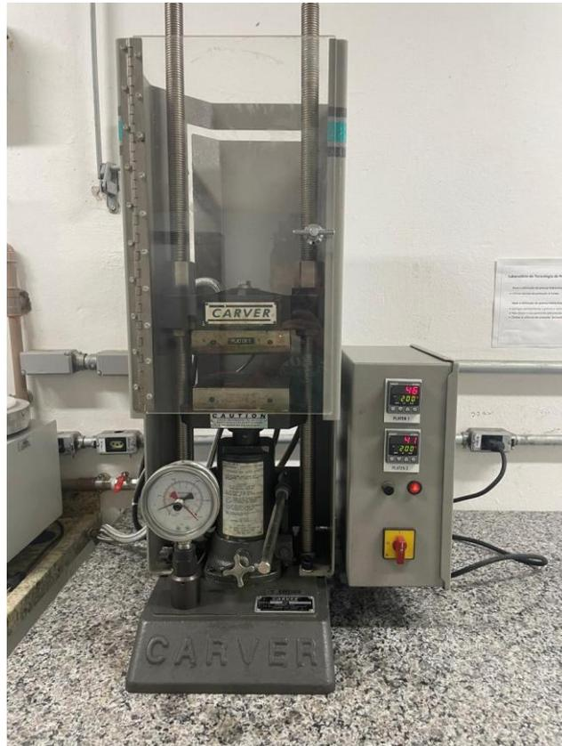
**Figura 14 - Prensa hidráulica usada para a confecção das placas quadradas, Laboratório TECPOL (IPRJ/UERJ), departamento de materiais, UERJ. (Fonte: o autor)**
