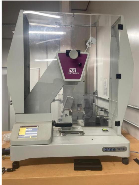
**Figura 18 - Máquina ensaio Izod, CEAST 9050, Laboratório TECPOL (IPRJ/UERJ), departamento de materiais, UERJ. (Fonte: o autor)**
