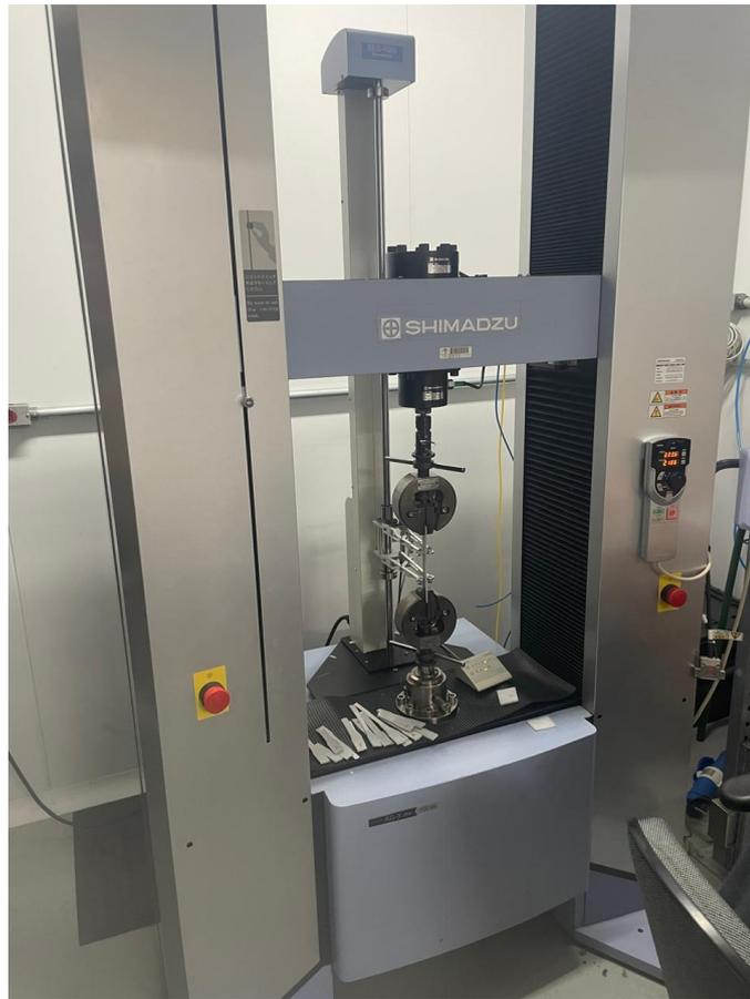
**Figura 17 -Máquina Universal de Ensaio SHIMADZU, Laboratório TECPOL (IPRJ/UERJ), departamento de materiais, UERJ. (Fonte: o autor)**
