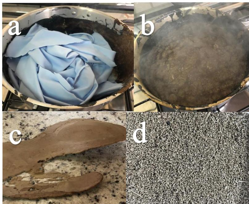
**Figura 9 - Processamento do material - (a) – Tecido (Microfibra) colocado na panela; (b) – Tecido completamente fundido; (c) tecido endurecido; (d) Material triturado (Fonte: o autor)**
