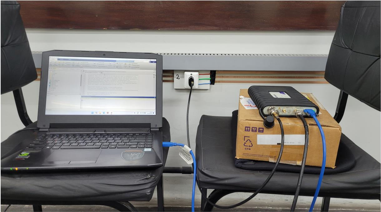
Figura 14: Conjunto de Sonda: Filtro passa-altas, Computador com Software SignalVU e analisador de espectro RSA306 da Tektronix.
