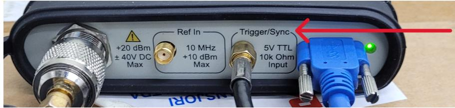
Figura 19: Porta "Trigger/ Sync" do Analisador de Espectro RSA306.
