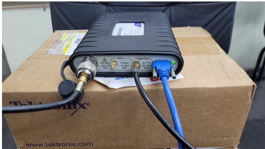
Figura 18: Analisador de Espectro RSA306 utilizado no experimento.
