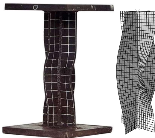
Figura 44 – Comparação com deformada final dos ensaios de Chen et al. [23].
