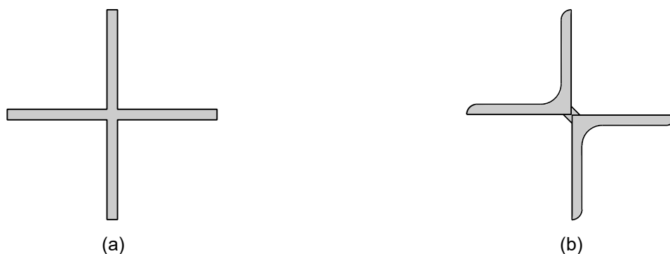
Figura 7 – Comparação entre seção cruciforme e starred : a) seção cruciforme e b) seção starred .
