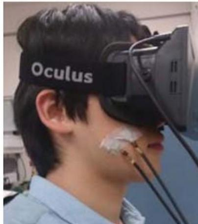
Legenda: Aplicação dos sensores de vibração para feedback tátil
